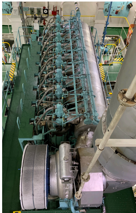
Ilustración 4: “Motor principal buque Tinerfe”
