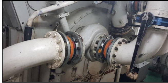
Ilustración 11: Bombas acopladas al motor agua refrigeración.
