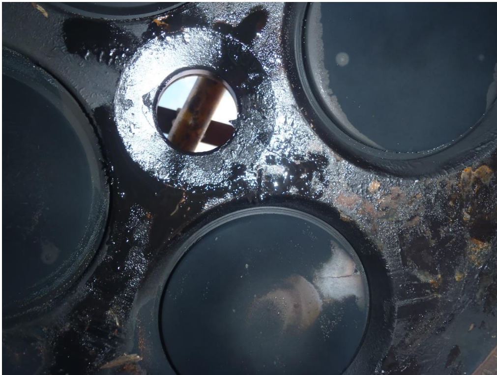
Ilustración 43 Ilustración de culata CAT 3618 presenta corrosión y grieta en la cabeza de la válvula. Fuente: Trabajo de campo.
