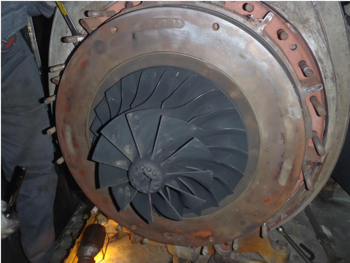
Ilustración 38 . Ilustración de una turbina de un turbo ABB modelo TPL 65 MMPP POME. Fuente: Trabajo de campo.
