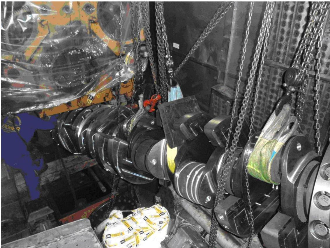
Ilustración 25 Ilustración extracción del cigüeñal. Fuente: Trabajo de campo.
