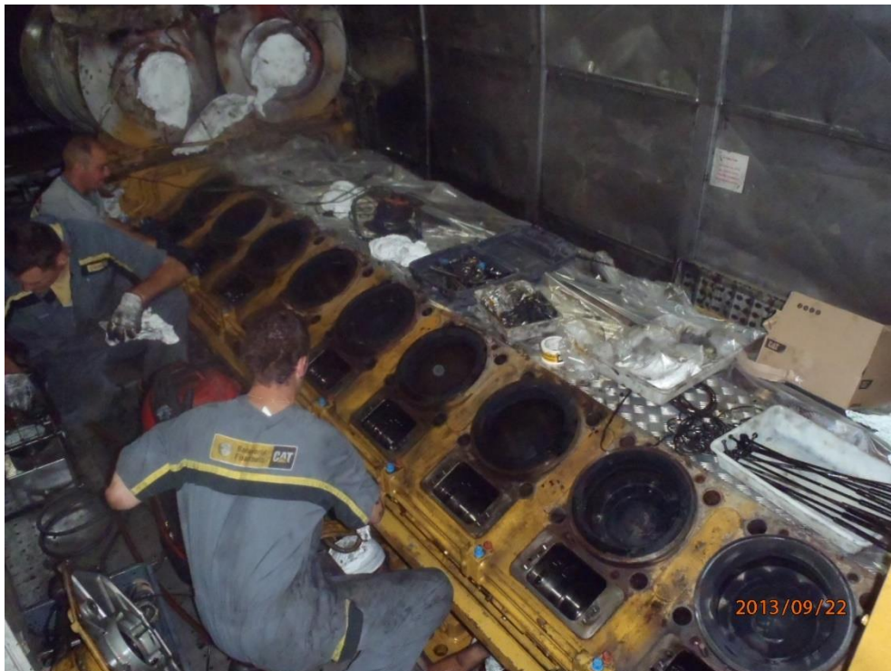
Ilustración 22 . Ilustración desmontaje de elementos contenidos en bloque motor principal. Fuente: Trabajo de campo.
