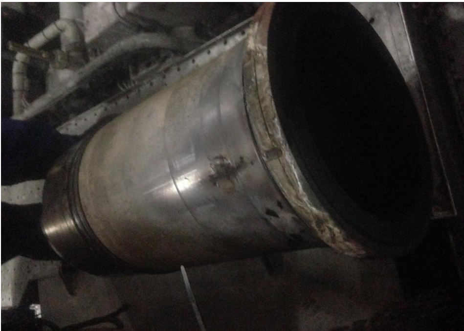
Ilustración 33 Ilustración cavitación camisa PIME cilindronº3. Fuente: Trabajo de campo.
