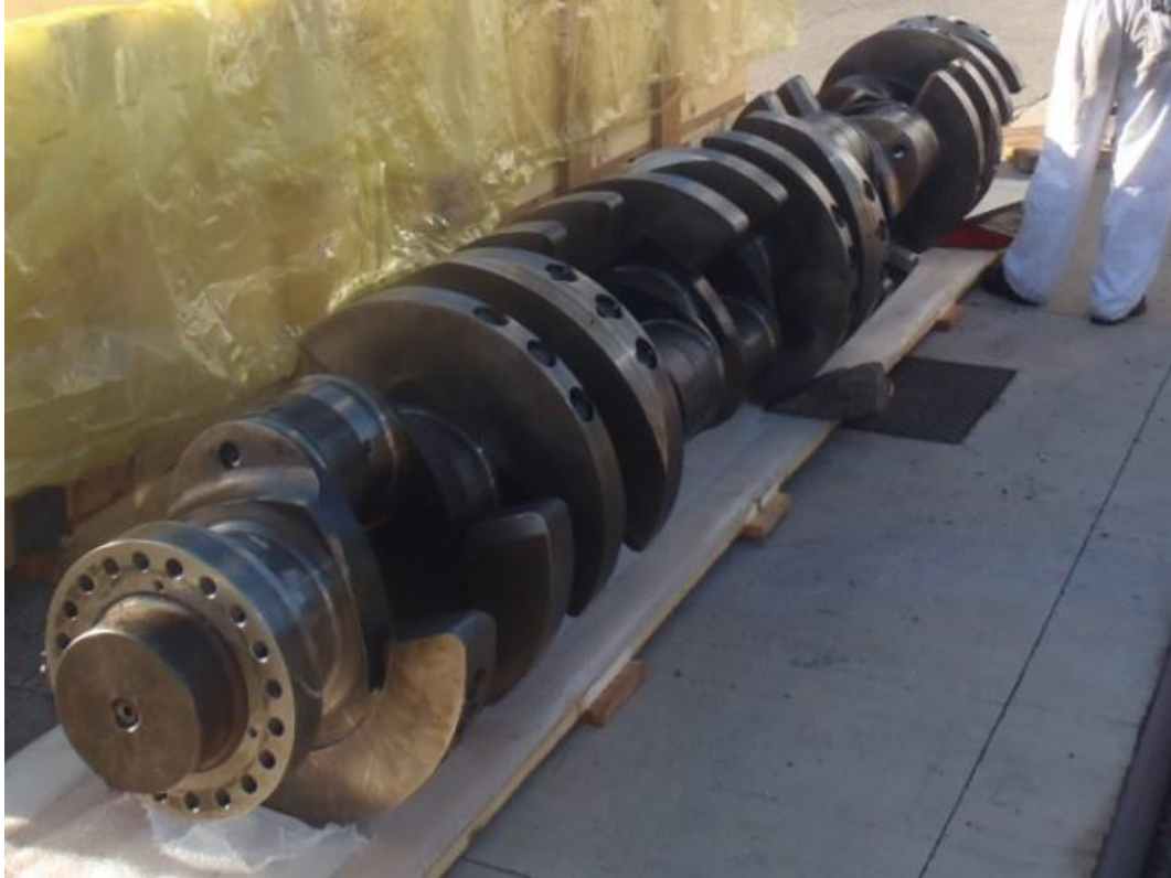
Ilustración 26 Ilustración extracción del cigüeñal. Fuente: Trabajo de campo.
