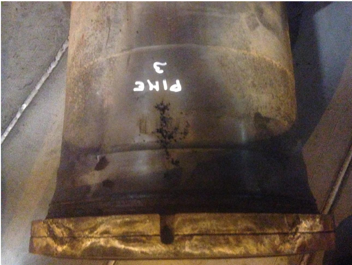
Ilustración 31 Ilustración sustitución camisa PIME por cavitaciones cilindronº3. Fuente: Trabajo de campo.
