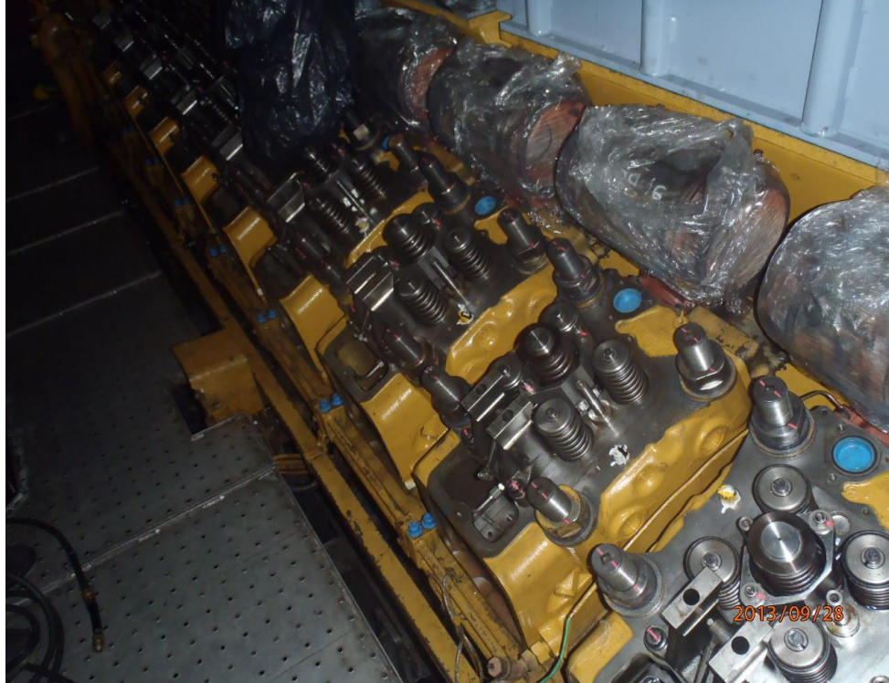
Ilustración 44 Ilustración de culatas independientes del CAT 3618. Fuente: Trabajo de campo.
