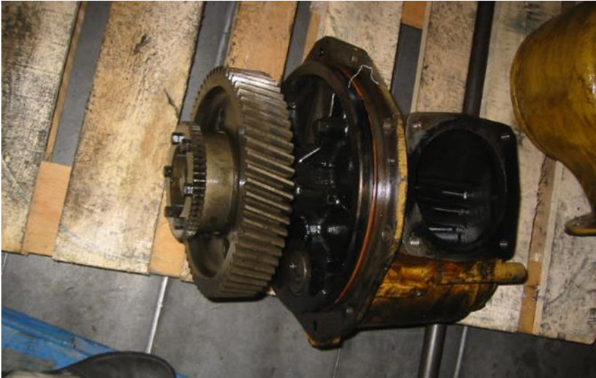
Ilustración 52 Ilustración de bomba de aceite de MMPP. Fuente: Trabajo de campo
