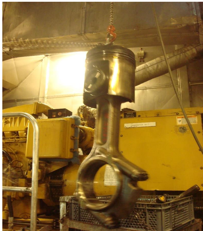
Ilustración 28 Ilustración extracción pistón unido a la biela de un MMPP. Fuente: Trabajo de campo.
