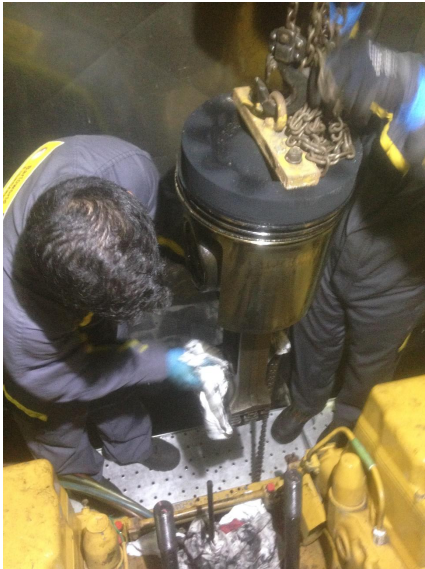
Ilustración 30 Ilustración extracción pistón nº15 del SIME. Fuente: Trabajo de campo.
