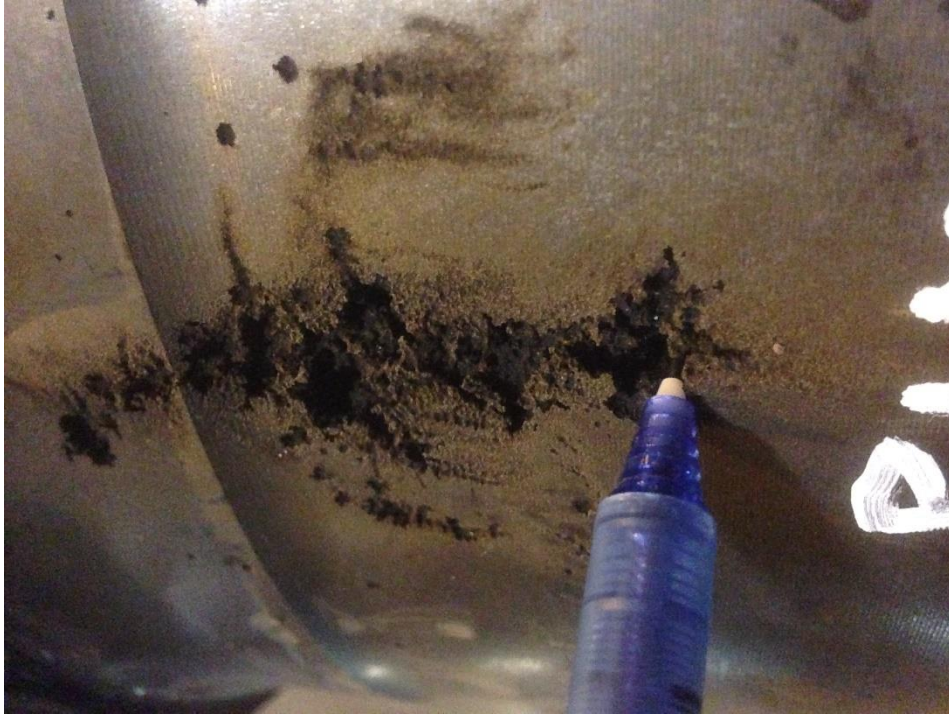
Ilustración 32 . Ilustración cavitación camisa PIME cilindronº3. Fuente: Trabajo de campo.
