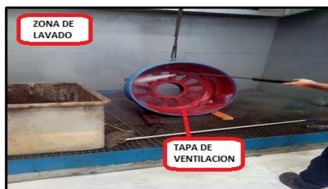
Ilustración 32. Lavado de tapa de ventilación. Fuente: Elaboración propia.
