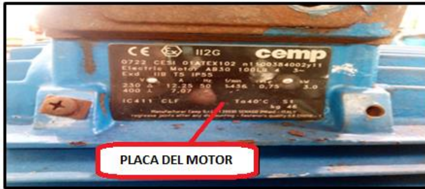
Ilustración 13. Placa de las características del motor asíncrono trifásico. Fuente: Elaboración propia.
