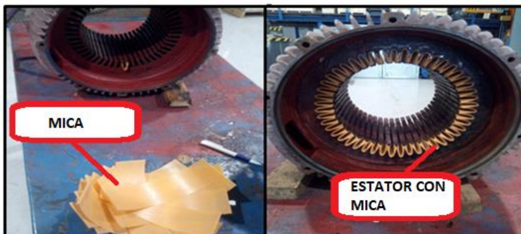
Ilustración 50. Material aislante y estator aislado. Fuente: Elaboración propia.
