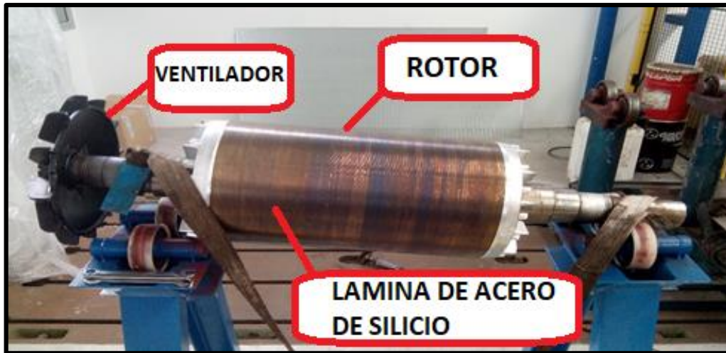
Ilustración 8. Rotor de jaula de ardilla simple. Fuente: Elaboración propia.
