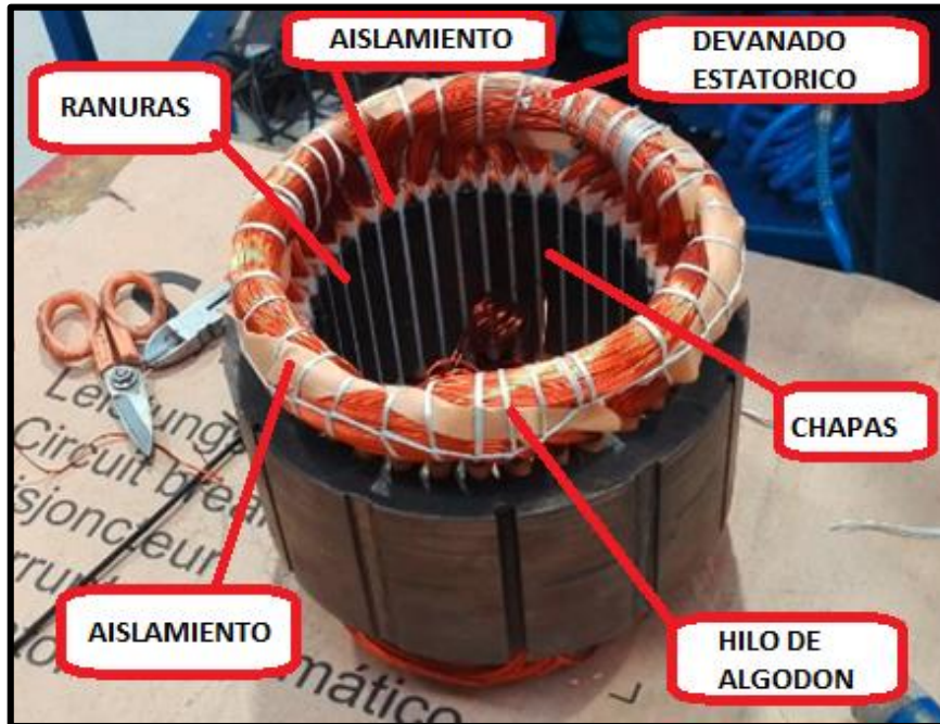
Ilustración 24. Devanado del estator. Fuente: Elaboración propia.
