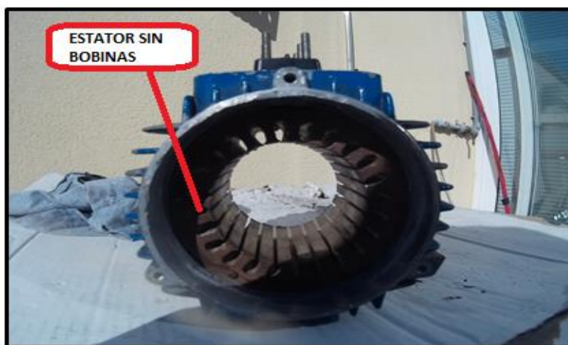
Ilustración 64. Resultado de extracción de las bobinas. Fuente: Elaboración propia.
