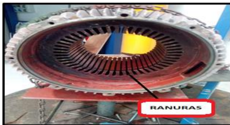
Ilustración 5. Estator ranurado sin bobinas. Fuente: Elaboración propia.
