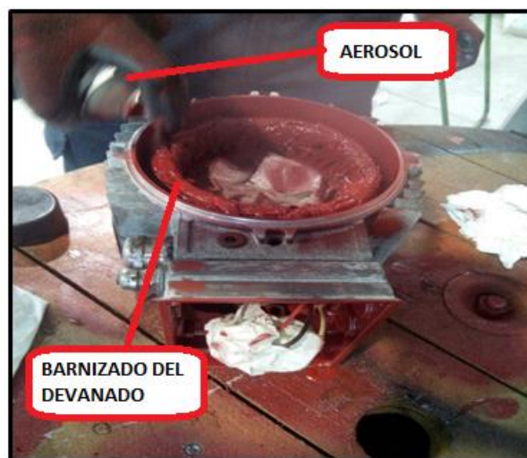
Ilustración 54. Aplicación de barniz con aerosol. Fuente: Elaboración propia.
