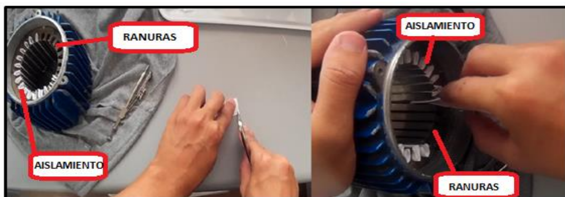
Ilustración 66. Introducción de aislamiento en las ranuras. Fuente: Elaboración propia.
