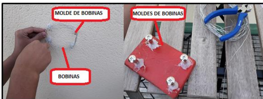
Ilustración 67. Elaboración de las bobinas mediante moldes. Fuente: Elaboración propia.
