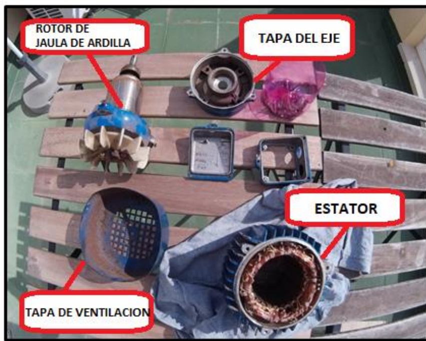
Ilustración 61. Descomposición de elementos del motor asíncrono trifásico. Fuente: Elaboración propia.
