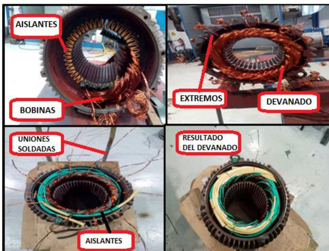
Ilustración 51. Colocación e hilado de las bobinas. Fuente: Elaboración propia.
