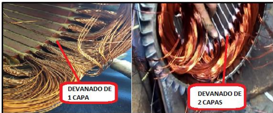
Ilustración 23: Devanados de 1 capa y 2 capas por ranuras. Fuente: Elaboración propia.
