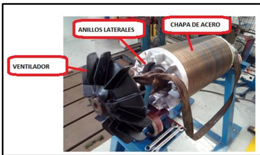
Ilustración 12. Rotor cortocircuitado de jaula de ardilla. Fuente: Elaboración propia.
