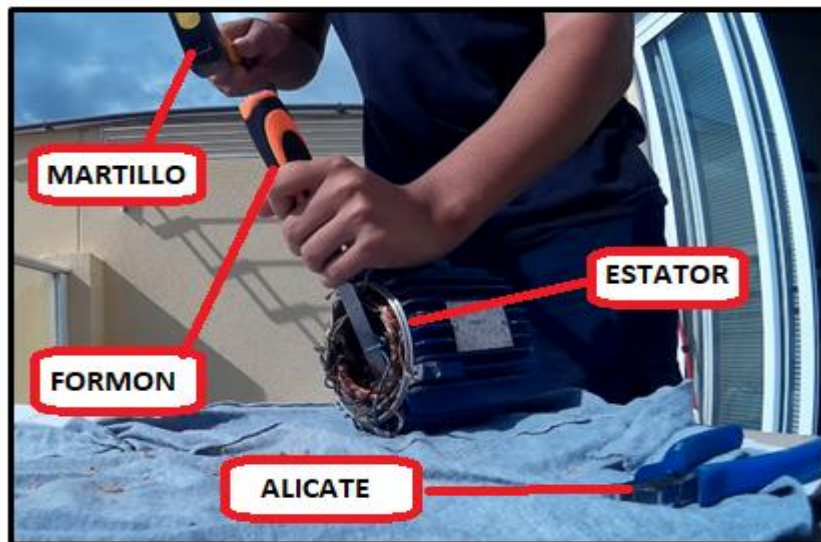
Ilustración 63. Extracción de bobinas sin aporte de calor. Fuente: Elaboración propia.
