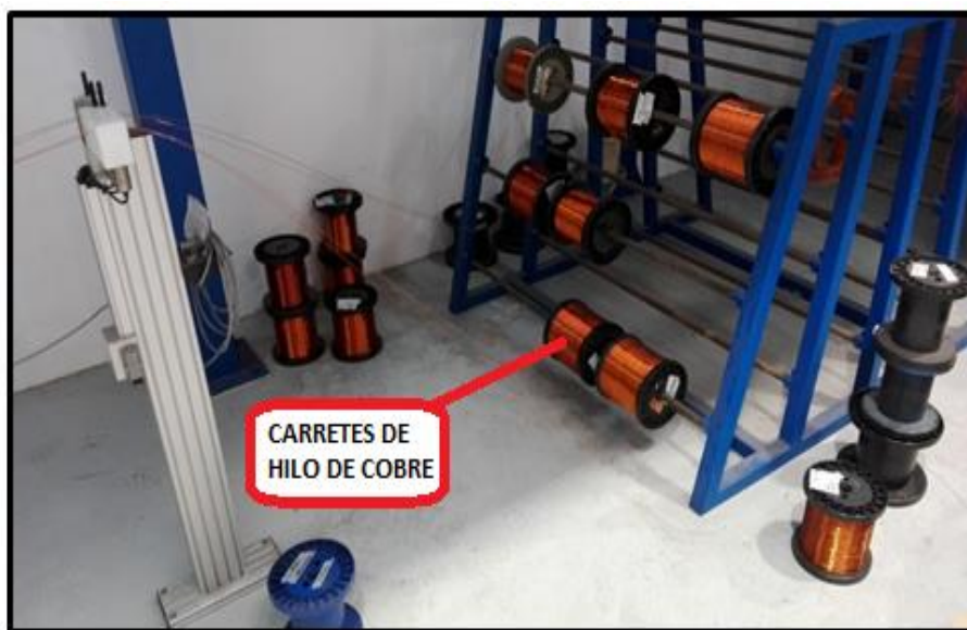
Ilustración 45. Carretes de hilos para la bobinadora automática. Fuente: Elaboración propia.
