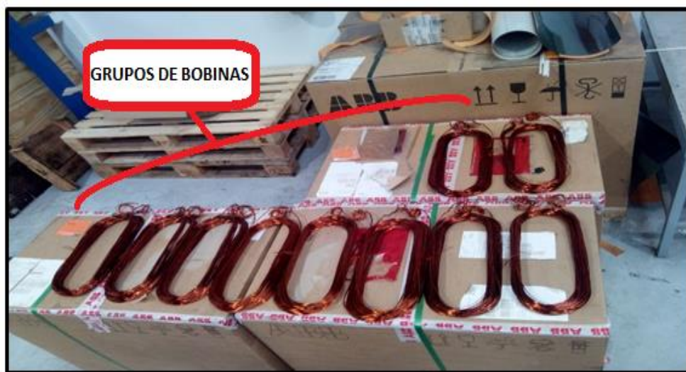
Ilustración 49. Grupo de bobinas. Fuente: Elaboración propia.
