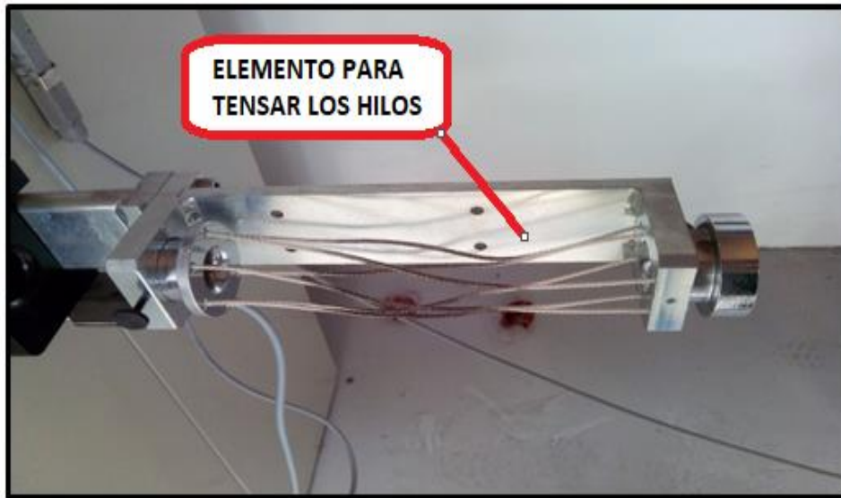
Ilustración 47. Elemento para tensar los hilos. Fuente: Elaboración propia.
