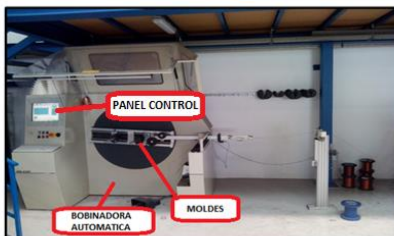
Ilustración 44. Bobinadora automática. Fuente: Elaboración propia.
