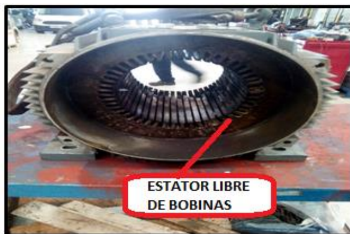
Ilustración 42. Resultado de extracción de bobinas mediante aplicación de soplete. Fuente: Elaboración propia.
