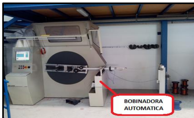
Ilustración 26: Máquina-herramienta bobinadora automática. Fuente: Elaboración propia.
