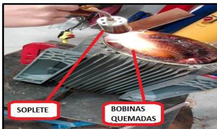
Ilustración 41. Extracción de bobina por aportación de calor. Fuente: Elaboración propia.
