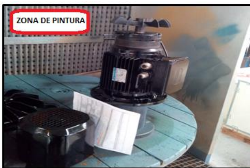
Ilustración 58. Motor eléctrico recién pintado. Fuente: Elaboración propia.
