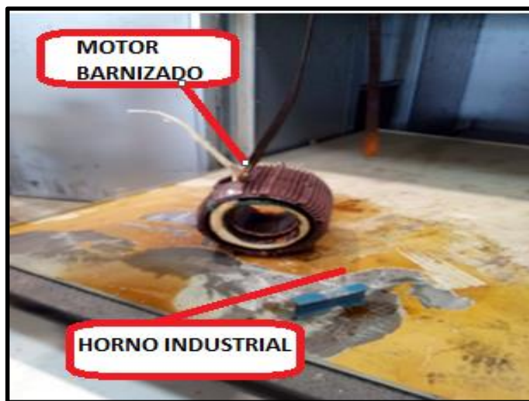
Ilustración 59. Operación de horneado. Fuente: Elaboración propia.
