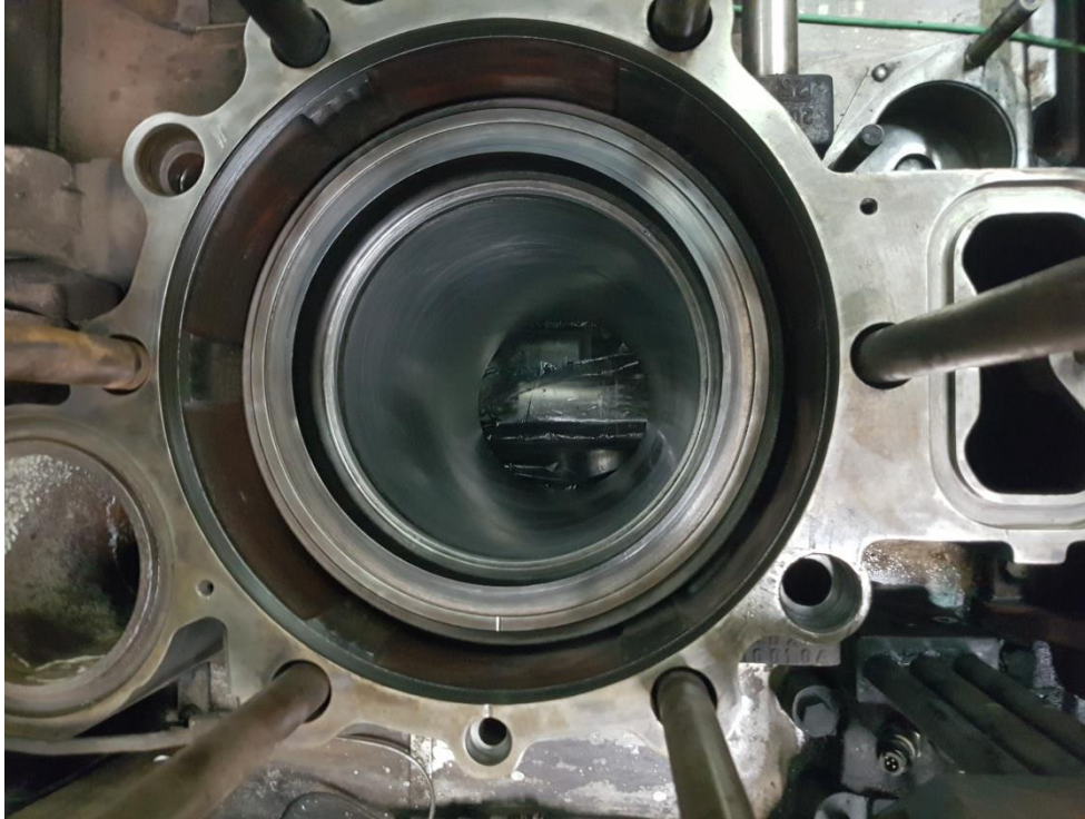
Ilustración 27. Camisa MP. Fuente. Trabajo de campo
