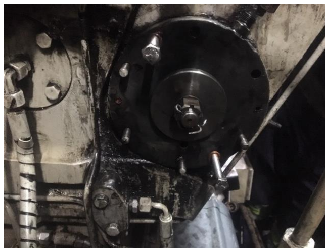
Ilustración 42. Tornillos extractores. Fuente. Trabajo de campo.
