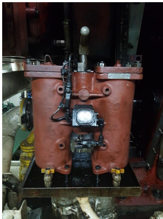
Ilustración 35. Filtro de aceite limpio. Fuente. Trabajo de campo
