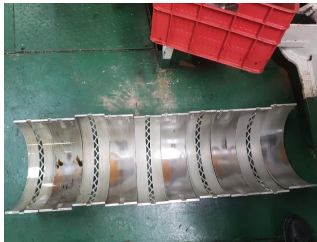
Ilustración 30. Cojinetes de Biela. Fuente. Trabajo de campo.
