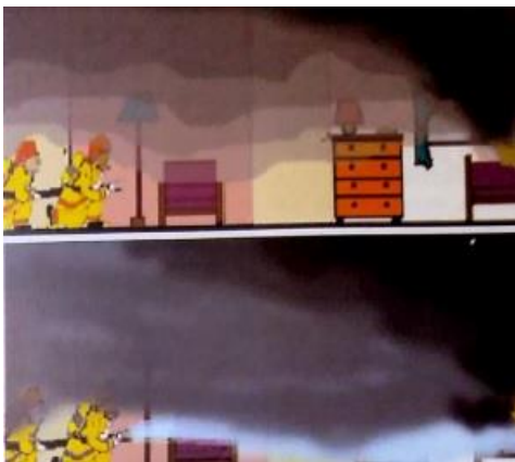
Imagen 21: Perturbación de la estratificación térmica por agua mal aplicada - Fuente: El Manual del Bombero Profesional. Tomo I
