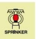
OMI-348 Espacio protegido por sprinklers
