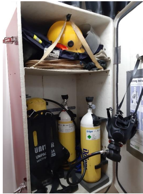
Imagen 41: Cajón contra incendios y material en su interior - Fuente: Buque Esperanza del Mar
