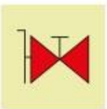
OMI-359 Válvulas de incendios
