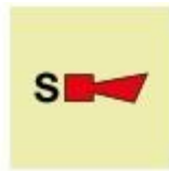
OMI-349 Alarma de sprinklers
