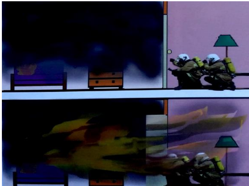
Imagen 16: Backdraft por apertura de puerta - Fuente: El Manual del Bombero Profesional. Tomo I
