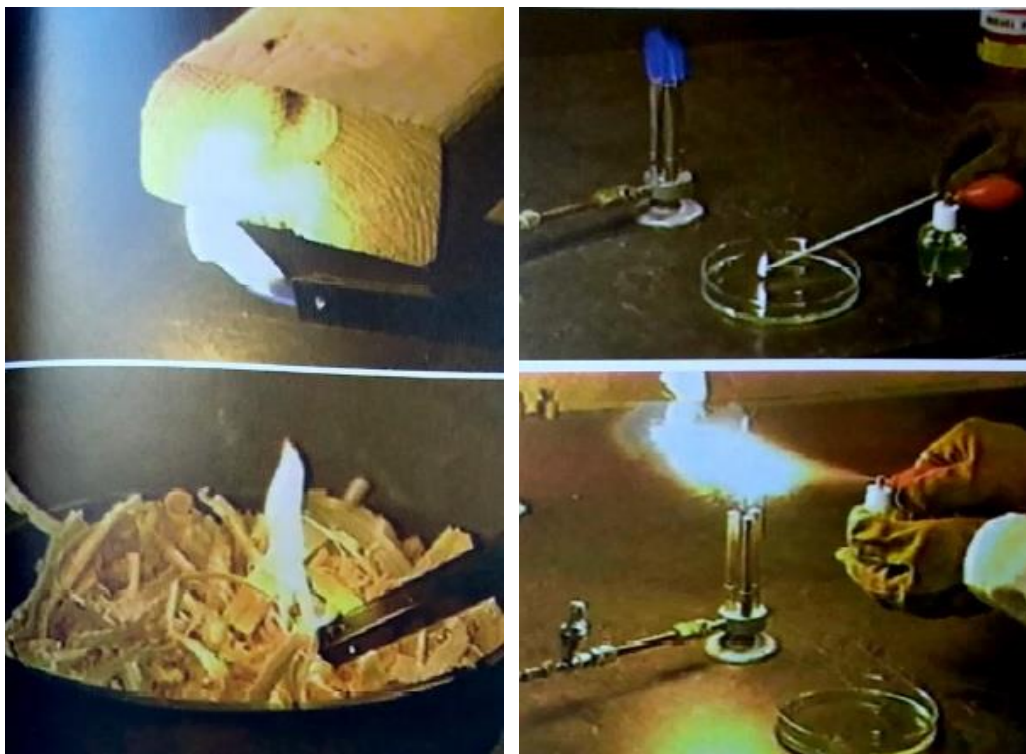
Imagen 7: Según su forma el combustible arde a diferentes velocidades - Fuente: El Manual del Bombero Profesional. Tomo I
