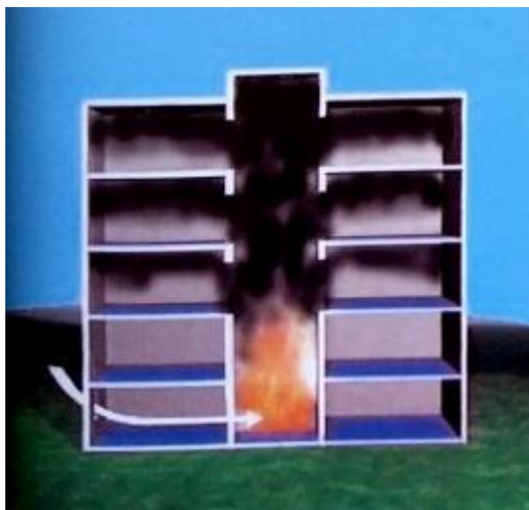
Imagen 10: Extensión del humo entre plantas - Fuente: El Manual del Bombero Profesional. Tomo I
