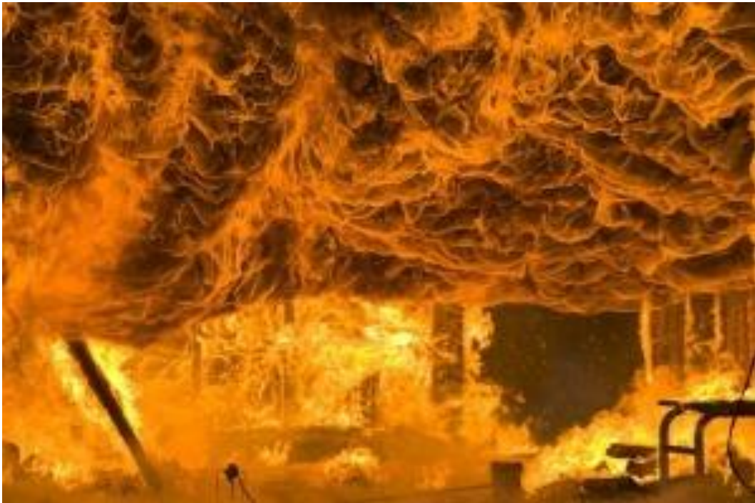
Imagen 15: Flashover en habitación común - Fuente: Mercotecresa.es
