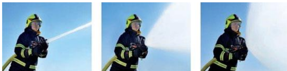
Imagen 56: Chorro, cono de ataque y cortina o pantalla defensiva en un lanza contra incendios - Fuente: AprendEmergencias
