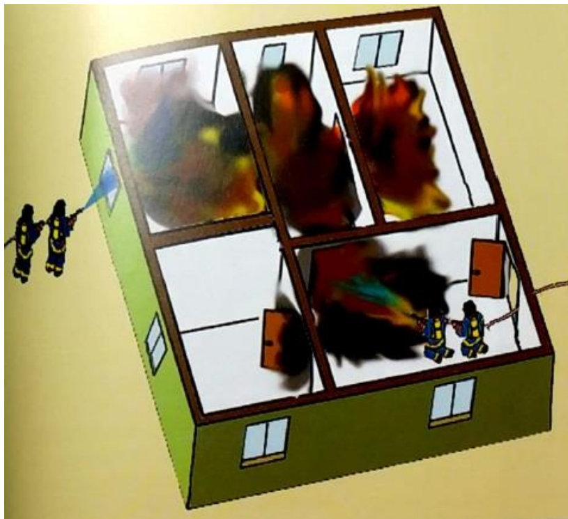
Imagen 25: Ataque combinado - Fuente: El Manual del Bombero Profesional. Tomo I
