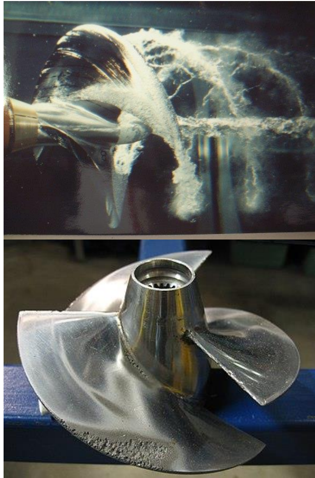
Figura 20: efectos de la corrosión por cavitación. Fuente: (20)
