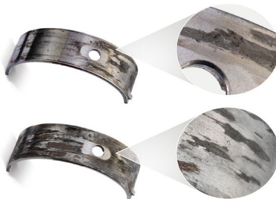
Figura 19: corrosión por fricción. Fuente: (19)
