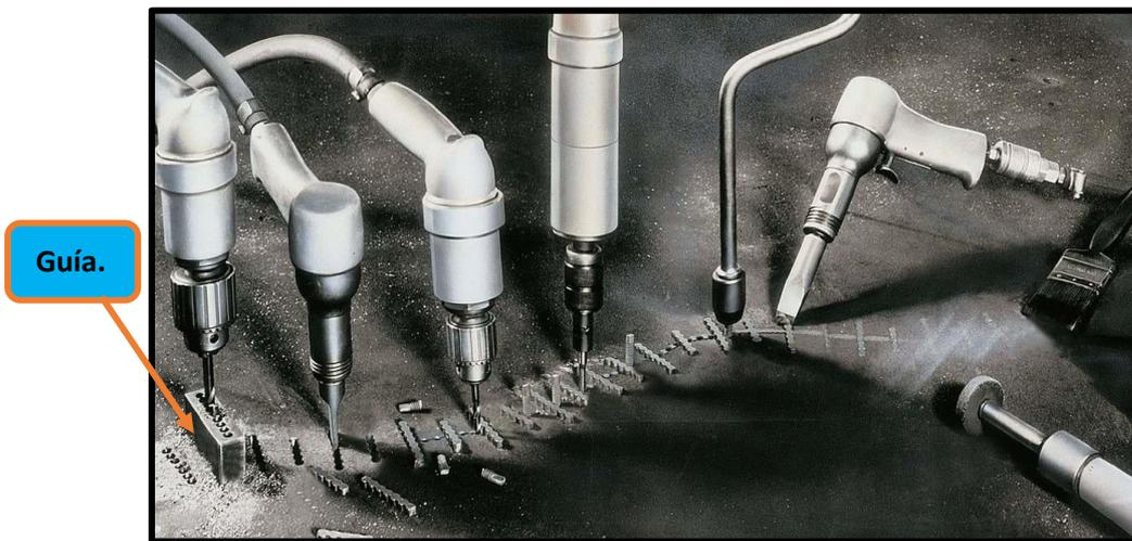
Ilustración n°96: Soldadura metallock
