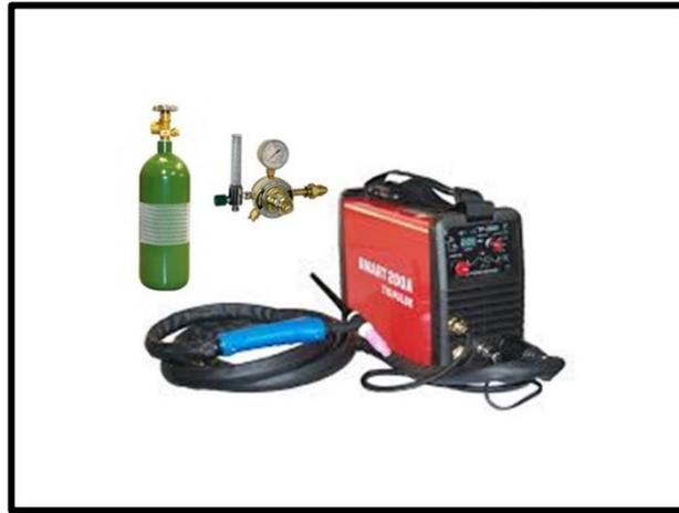
Ilustración n°36: Equipo soldadura TIG
