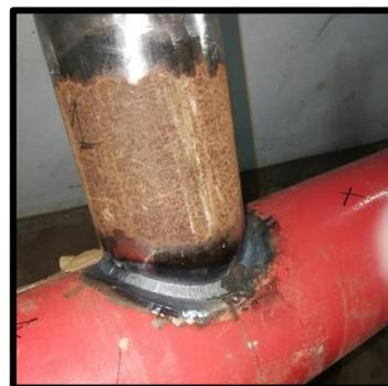
Ilustración n°70: Tubo unido al colector
