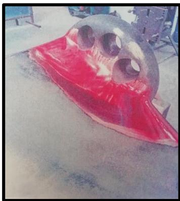
Ilustración n°98: Líquido penetrante
