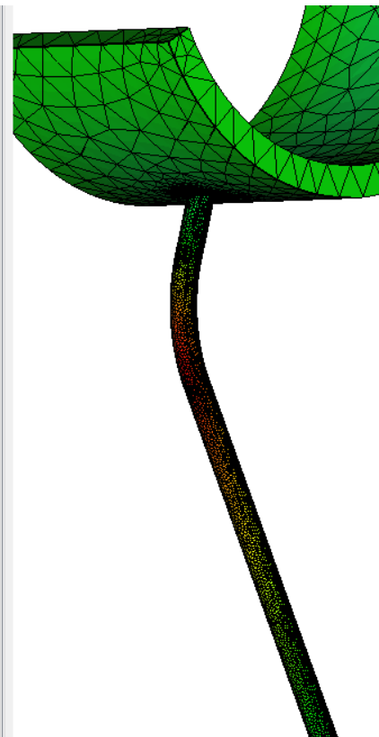
Figura B.10: Desplazamiento en el eje Z en el banco de tubos frontal del generador
