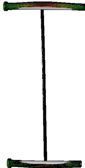
Figura E.14: Desplazamiento absoluto en el muro de tubos frontal del generador
