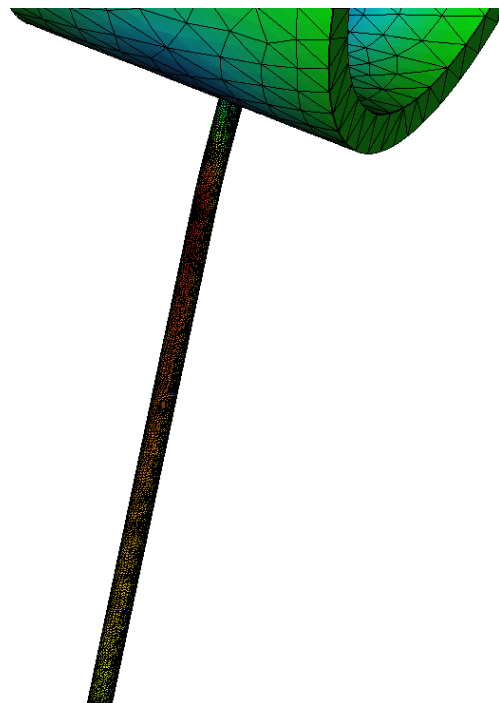
Figura C.10: Desplazamiento en el eje Z en el banco de tubos trasero del generador
