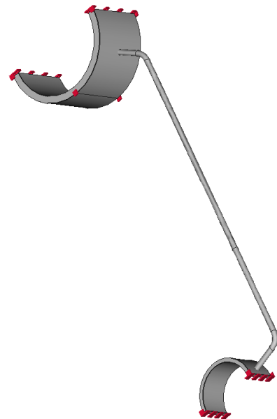
Figura 3.14: Restricciones estáticas en el generador
