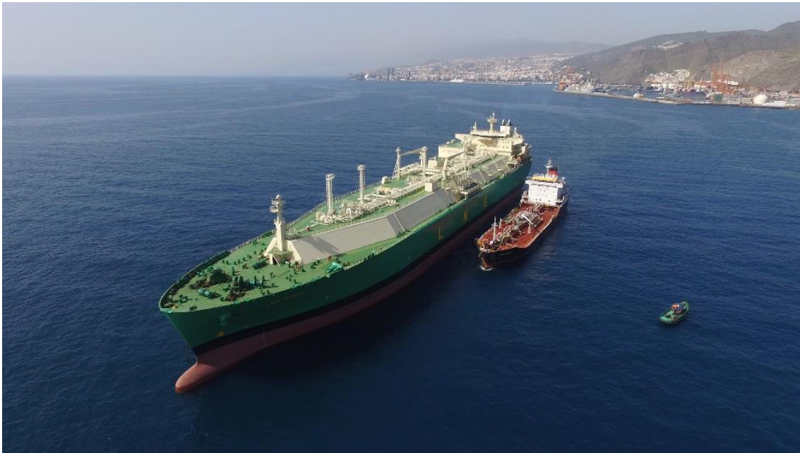
Ilustración 15. Proceso de "Bunkering"
