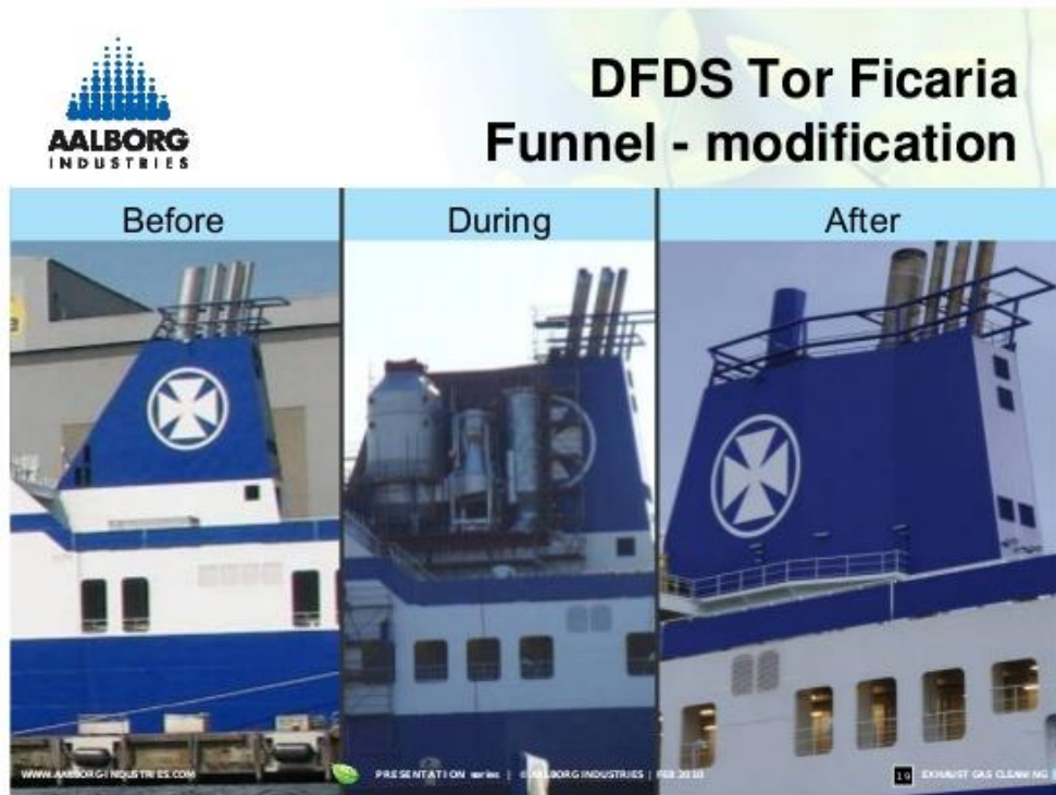
Ilustración 16. Instalación scrubber en buque de la Naviera "DFDS Seaway"
