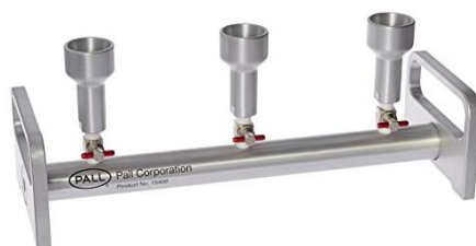
Figura 2. Rampa de filtrado PALL modelo N°15402 utilizada para el filtrado de las muestras.
