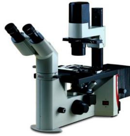
Figura 3. Microscopio invertido Leica DMIL utilizado para la visualización de las AVL.
