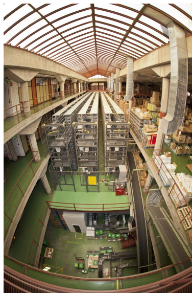
Imagen: Sistema de robotización en la parte central del edificio.
