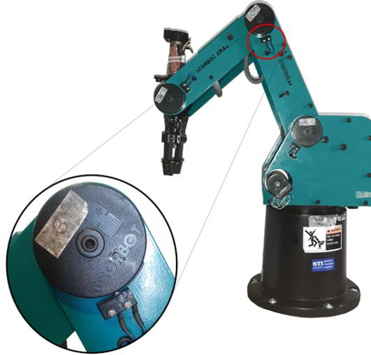
Figura 3.7: Detalle de un micro-interruptor
