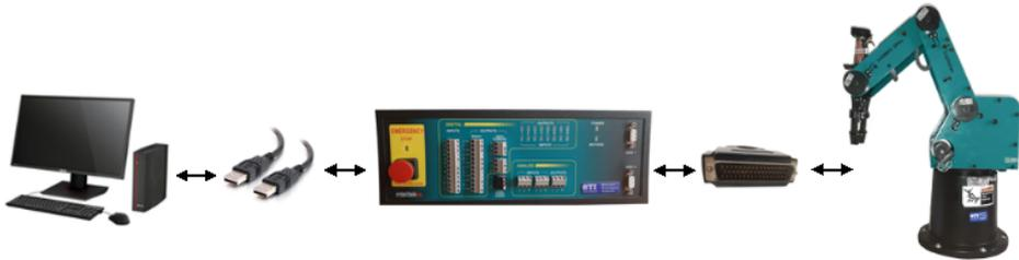
Figura 3.1: Conexión de los equipos
