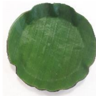
Figura 49. Vista de planta de un plato fabricado a partir de hojas de platanera en el trabajo de Leydi Ramona Pérez Hernández (TFG en proceso, 2019)
