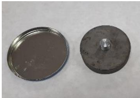
Figura 47. Tapas del molde metálico para la fabricación de los platos en el trabajo de Leydi Ramona Pérez Hernández (TFG en proceso, 2019)
