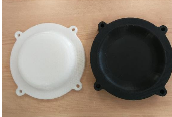
Figura 44. Molde de PLA empleado para el conformado de los "Ecoplatos" [XXXIX]
