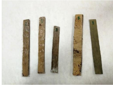
Figura 42. Probetas hechas de hojas y badana de platanera, y adhesivo a base de almidón [XXXIX]
