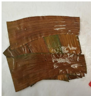
Figura 43. Unión de varios fragmentos de hoja de platanera para alcanzar el tamaño requerido por el molde [XXXIX]
