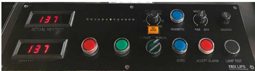
Figura 17. Panel piloto automático. Fuente: Trabajo de campo.
