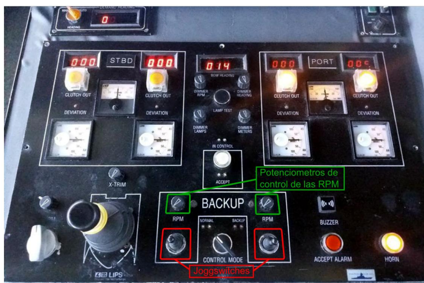
Figura 26. Controles en modo Back-up. Fuente: Trabajo de campo.
