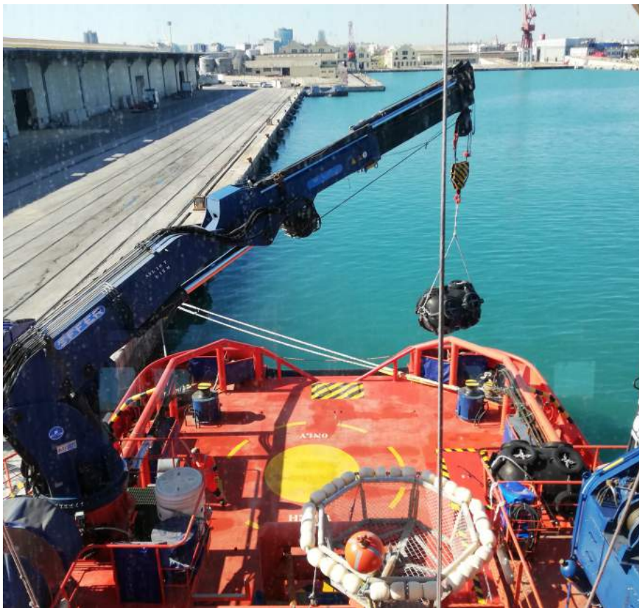
FIGURA 2.5: Grúa instalando Yokohama. (E. Arévalo 2019)
