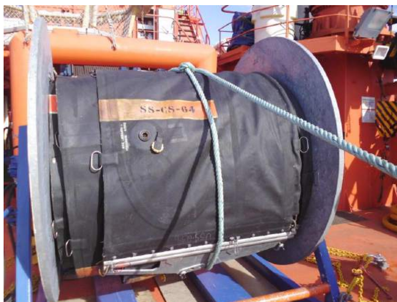
FIGURA 2.9: Barrera anticontaminación. (E. Arévalo 2019)
