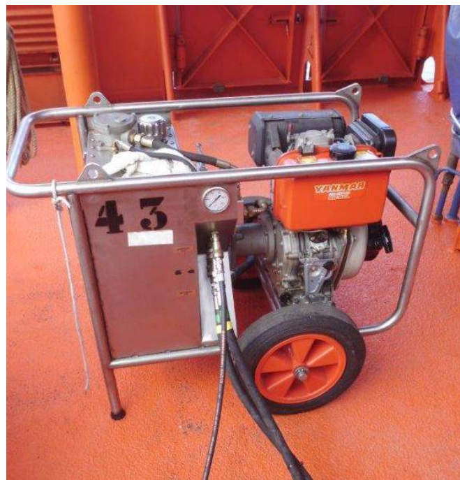
FIGURA 2.10: Unidad Hidráulica de Potencia. (E. Arévalo 2019)
