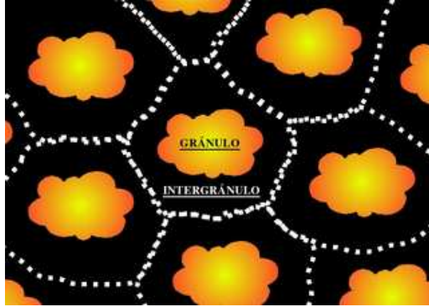
Figura 3.4: Esquema donde se ilustra el concepto de gránulo, intergránulo y celda granular. Cada celda granular se separa en dos regiones: la correspondiente a la parte de mayor contraste (gránulo) y la región oscura más cercana al antedicho cuando se hace una división equitativa entre las celdas granulares adyacentes (intergránulo). De esta forma, A_c = A_g + A_{ig} .
