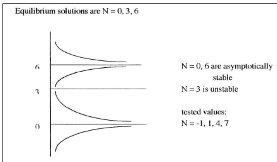
Imagen 1.4.1: Esquema para analizar la estabilidad de las soluciones de una EDO
