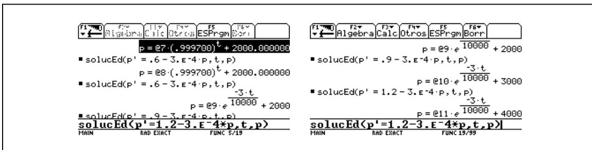
Imagen 5.4.1.15: Resolución de EDO con la Voyage<sup>TM</sup>200
