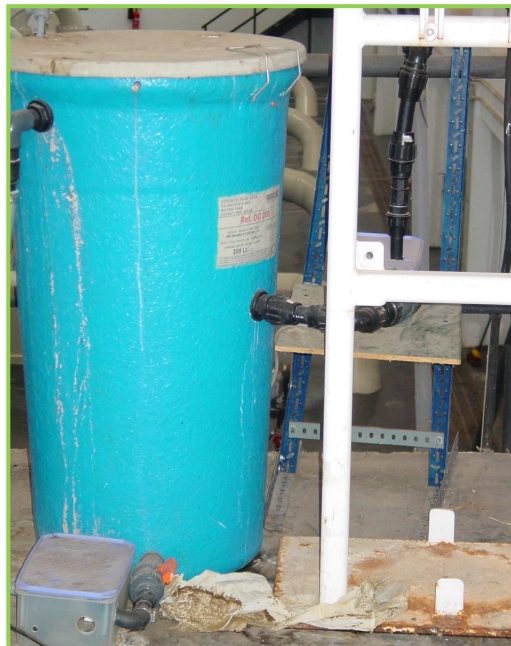
Figura 3.11. Fotografía del reactor RDS a escala piloto
