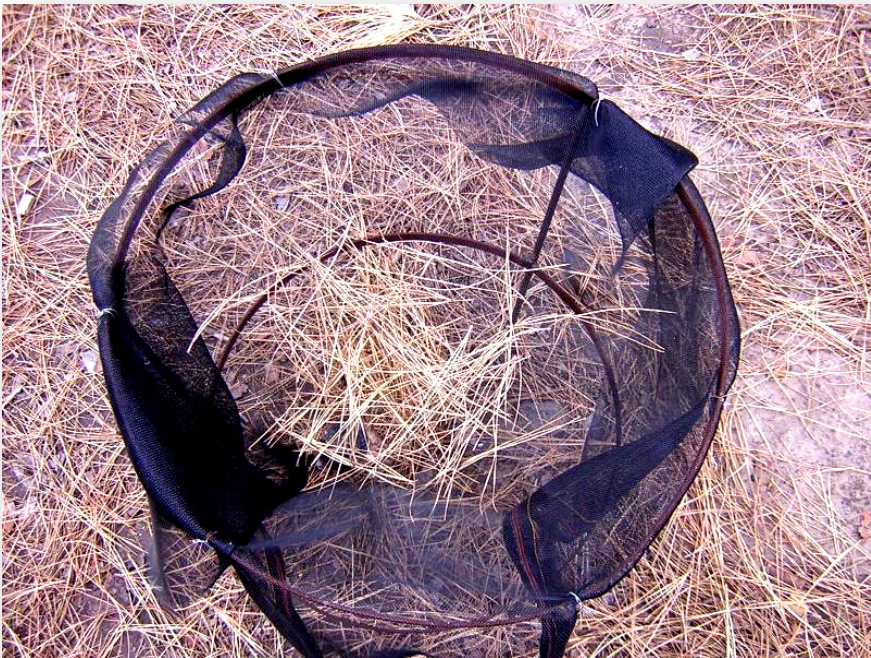
Foto 3.2. Cesta de recogida de lluvia de semillas. En el fondo de la red se colocó un peso para evitar el vuelco del contenido por acción del viento.
