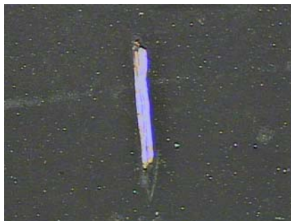
Figura 7: Foto del defecto establecido donde se aprecia el metal desnudo en el fondo del mismo antes de ser sumergido en una disolución de NaCl 10 mM.
