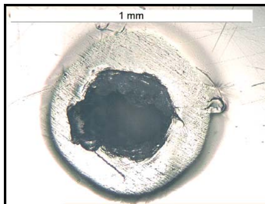
Figura 18: Microfotografía óptica de un defecto producido a una lámina de metacrilato. La imagen se tomó previamente a su inmersión en KCl 0.1 M.
