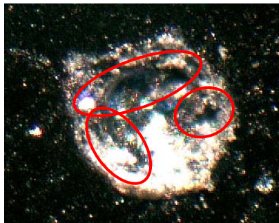
Figura 12: Fotografía del defecto aplicado al polímero inmerso en una disolución de sulfato de sodio 0.1 M donde se aprecian restos de polímero en el fondo del mismo en los instantes iniciales de inmersión.
