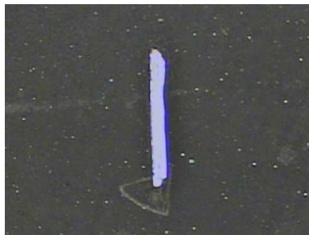
Figura 3: Foto del defecto generado donde se aprecia el metal desnudo en el fondo del mismo antes de ser sumergido en la disolución de ensayo.
