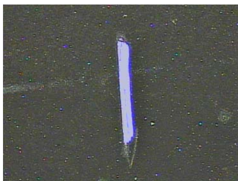
Figura 2: Defecto realizado en la probeta pintada dejando al descubierto el metal base (acero al carbono).
