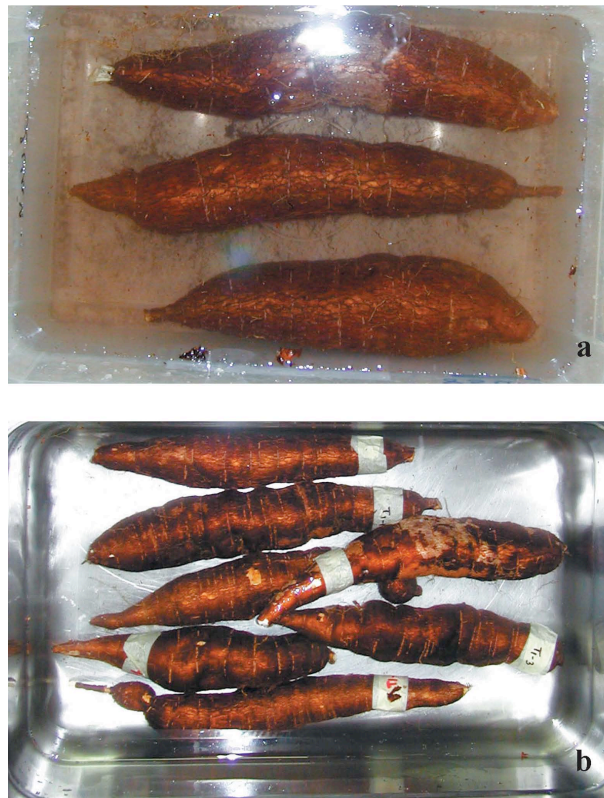
Foto 6. Lavado con cepillado (a) y lavado mediante inmersión de la yuca entera (b).
