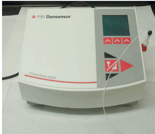
Foto 8. Analizador de dióxido de carbono y de oxígeno para determinar la composición de la atmósfera en el interior de los envases.
