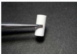
**Figura 4.2.-** Implante cilíndrico de brushita-chitosano
