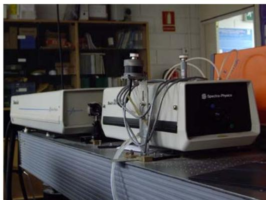
Figura 4.1. Láser continuo de Argón acoplado a un láser continuo de Titanio: zafiro.
