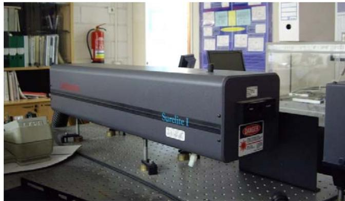
Figura 4.2. Láser pulsado de Nd: YAG con doblador de frecuencia.
