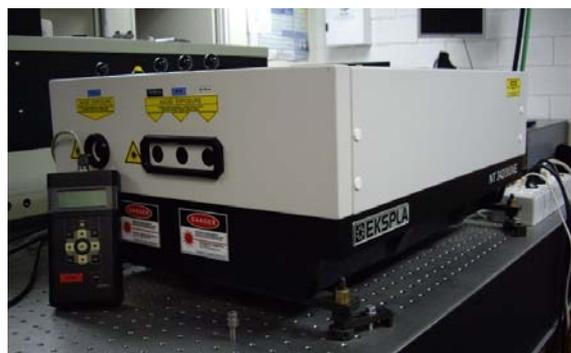
Figura 4.3. Oscilador paramétrico óptico, OPO
