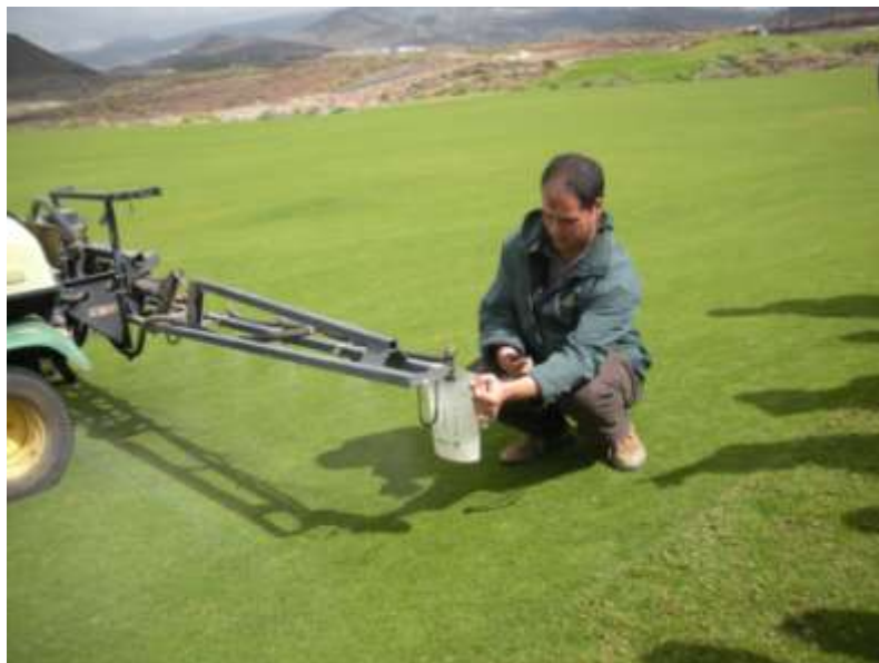
Fig.1.26 GreenKeeper calibrando la máquina de tratamiento fitosanitario, imprescindible para realizar una correcta aplicación
