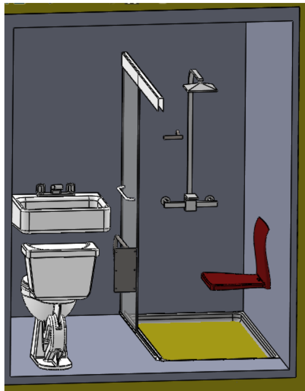
Ilustración 31. Aseo habitación personas movilidad reducida. Fuente Propia
