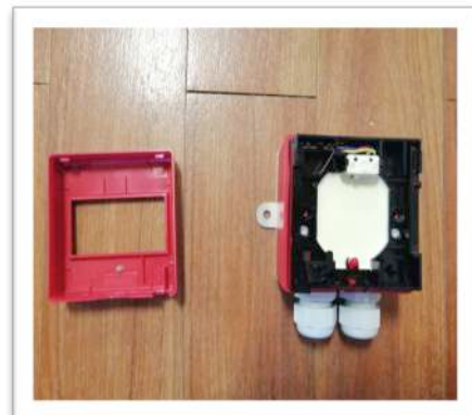
Ilustración 16 PULSADOR DE ALARMA
