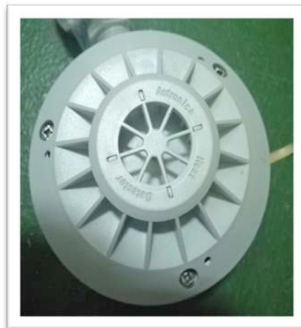
Ilustración 22 DETECTOR DE CALOR
