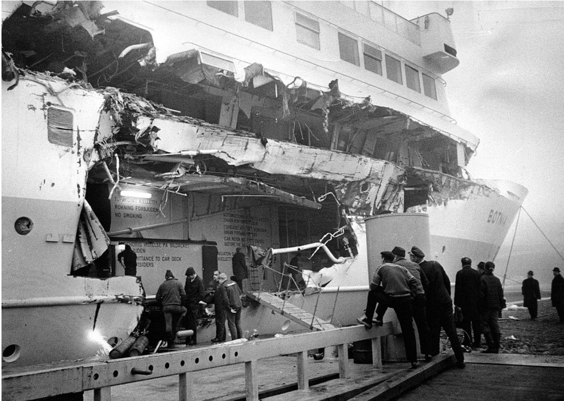
Ilustración 3. Costado del Botnia tras su colisión con el Ilmatar fotografiado en el puerto de Turuk. Fuente: commons.wikimedia.org
