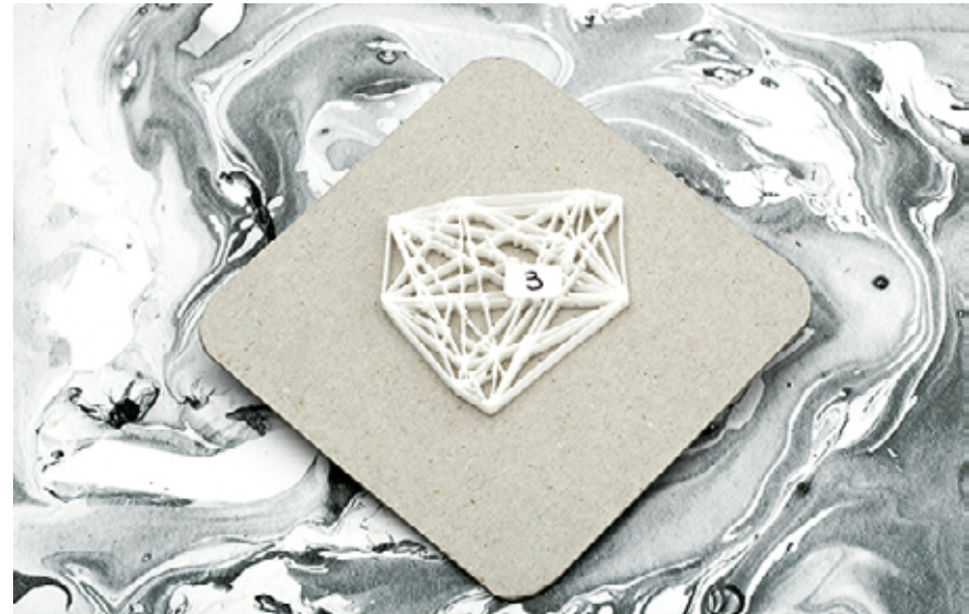
Prueba número 3, se puede apreciar las paredes quebradas de la pieza.
