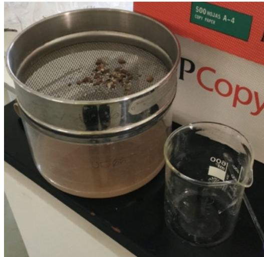
Figura 4. Separación de la fracción  $> 2$  mm y  $< 2$  mm. (Foto J. Zimmermann).
