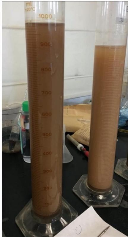
Figura 7. Probetas para la medición de la densidad. Foto J. Zimmermann.
