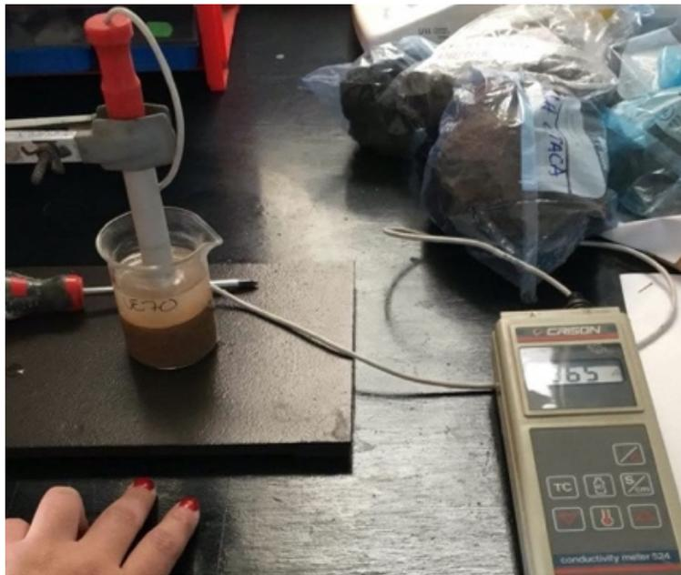
Figura 10. Conductímetro Crison. Foto J. Zimmermann.
