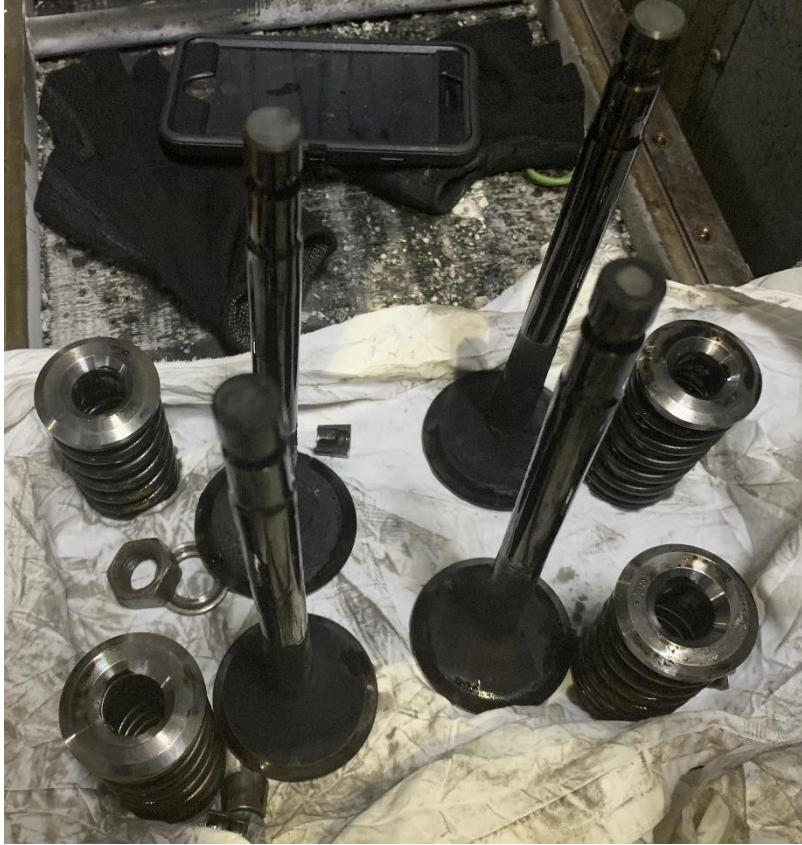
Ilustración 23: “Válvulas y muelles de una culata de un MMPP”
