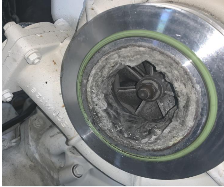
Ilustración 47: “Turbocompresor de alta contaminado”
