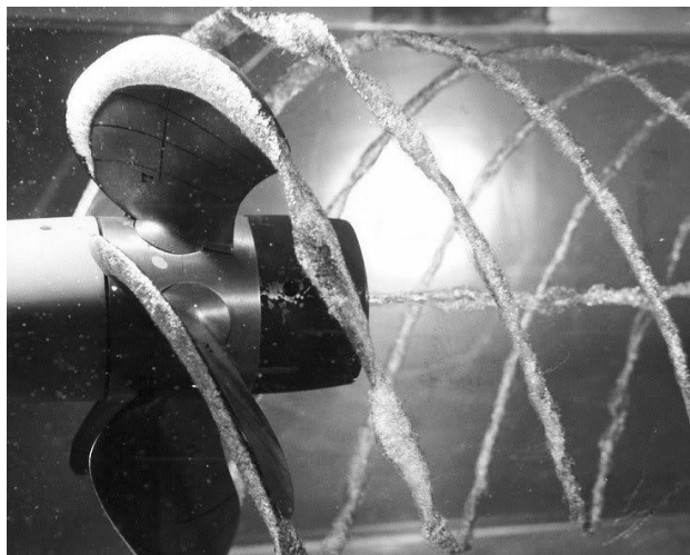
Foto 15: Cavitación de una hélice. Fuente:
