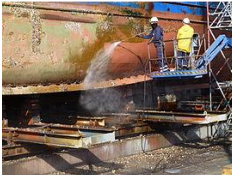
Ilustración 21: Limpiando con chorro de agua a presión el casco de un buque pesquero
