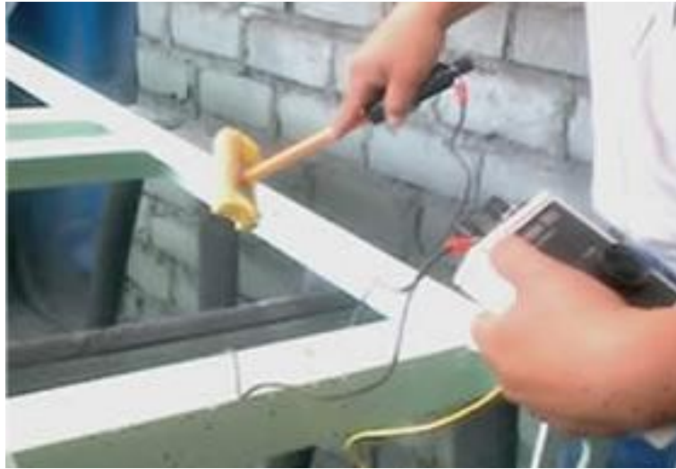
Ilustración 20: Detectando porosidad en la capa de pintura
