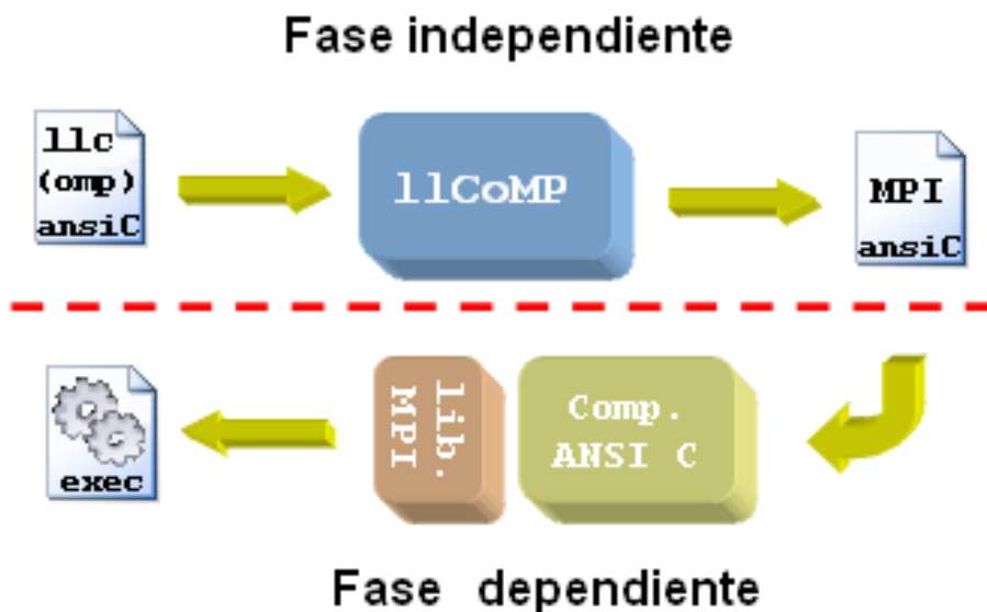
Figura 3.1: Proceso de generación de un ejecutable a partir de un código fuente 11c
