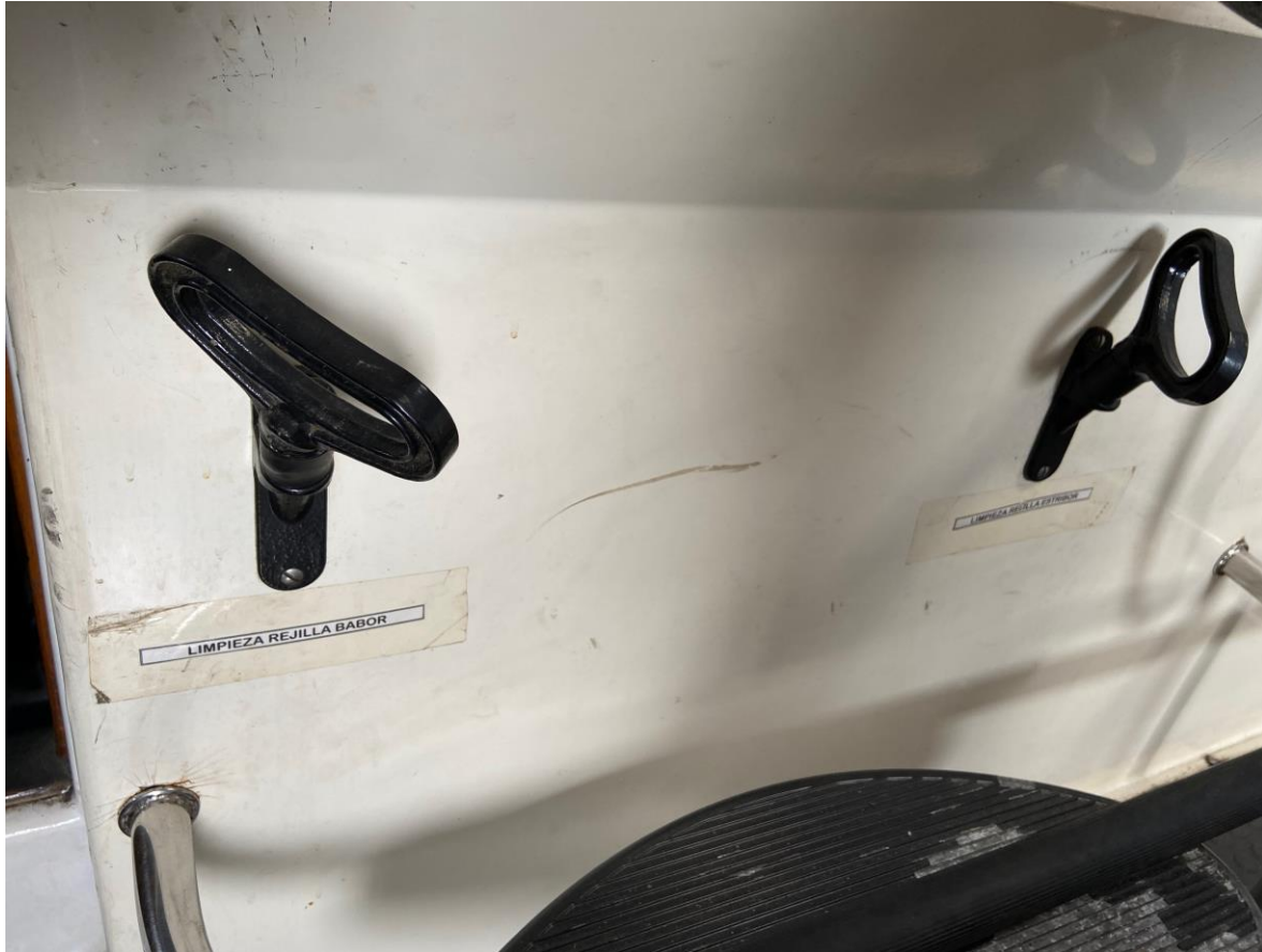
Ilustración 19: Sistema de limpieza manual de aspiraciones
