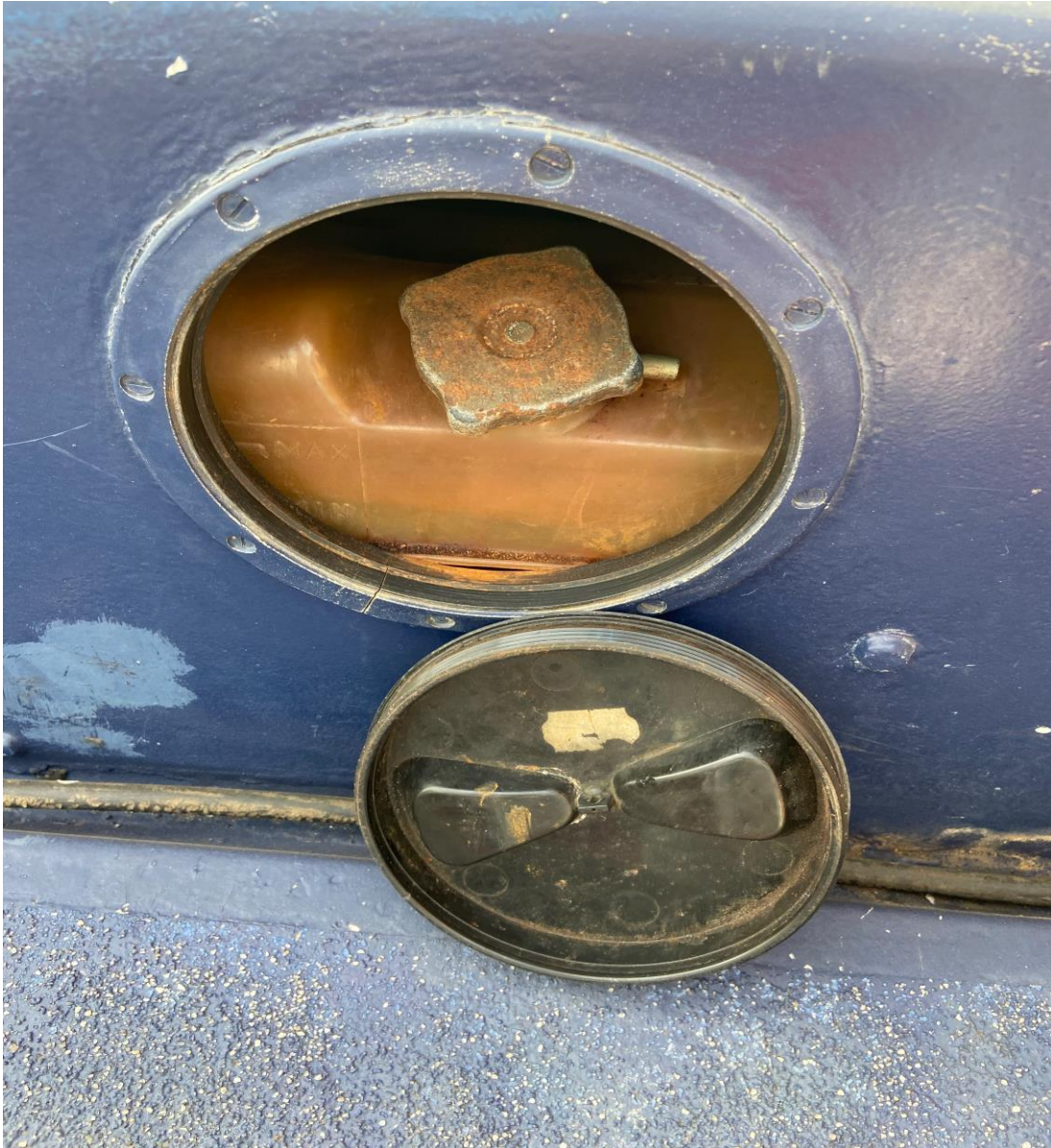
Ilustración 13: Depósito de refrigerante
