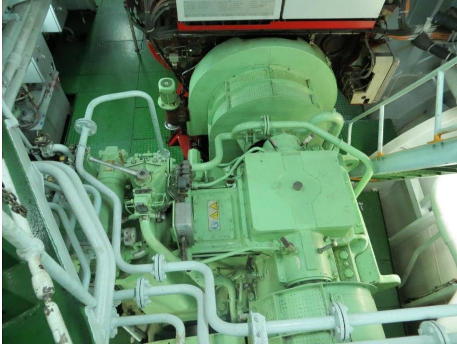
Ilustración [27] Vista de una reductora marina
