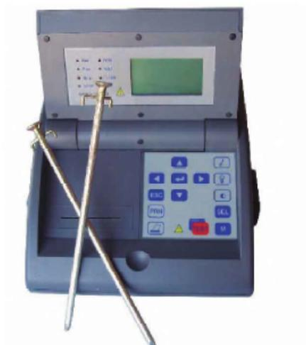
*Ilustración 39: Telurómetro [10]*
