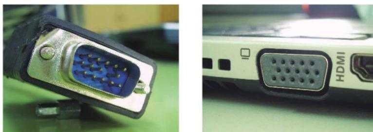
Ilustración 14: Conector tipo D, VGA macho (izda.) y hembra (dcha.) [9]
