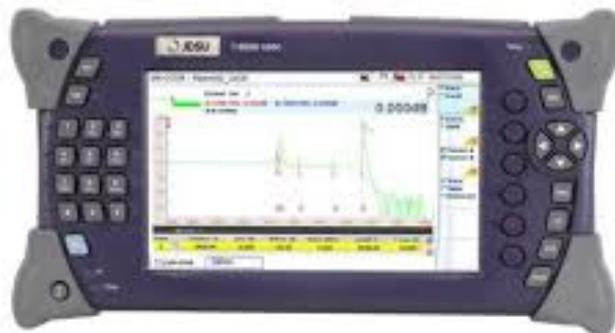
Ilustración 32: Reflectómetro o TDR [10]
