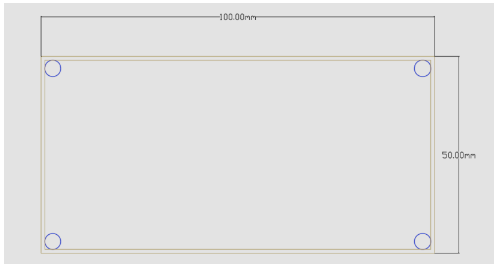
Figura 3.13. Dimensiones del diseño de la PCB del circuito.
