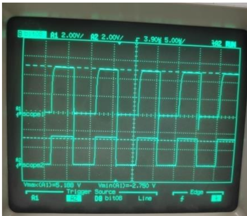
Figura 4.4. Resultados a la salida del circuito con una señal cuadrada de 100 kHz
