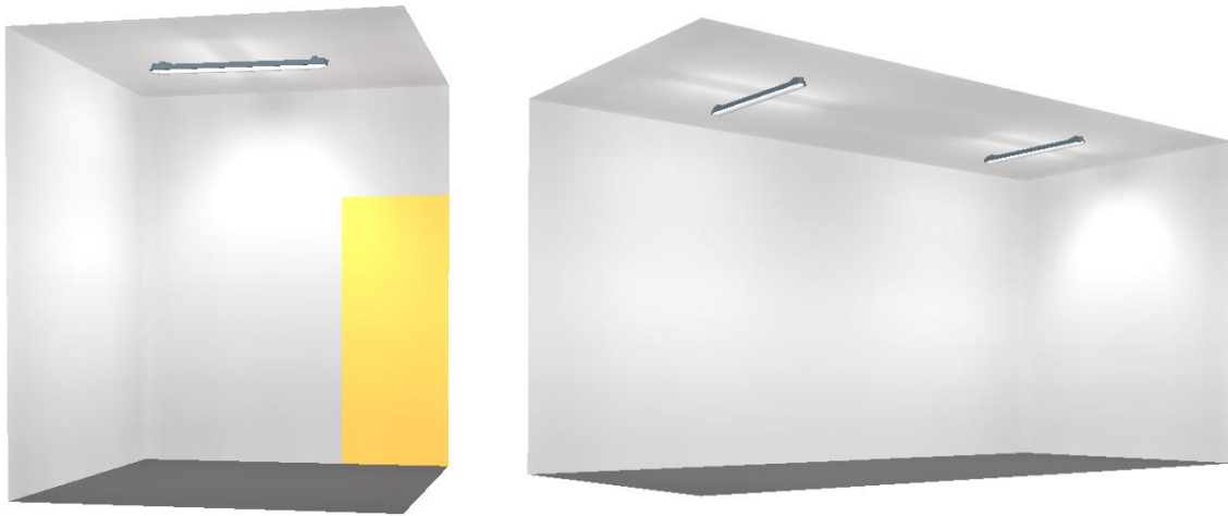
Ilustración 24. Vista 3D de la iluminación de los trasteros, a la izquierda el trastero de 5,6 m 2 , y a la derecha el de 13,3m 2 . Fuente. Elaboración propia usando el software DIALux.
