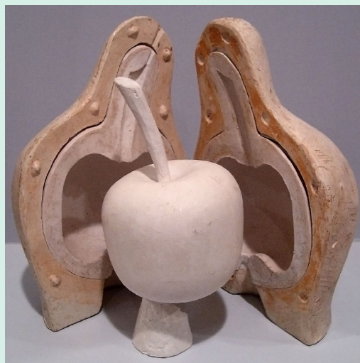
Moldeo a la cera perdida: creación de modelo y su molde de una manzana en escayola. Fuente: José-Manuel Benito.
