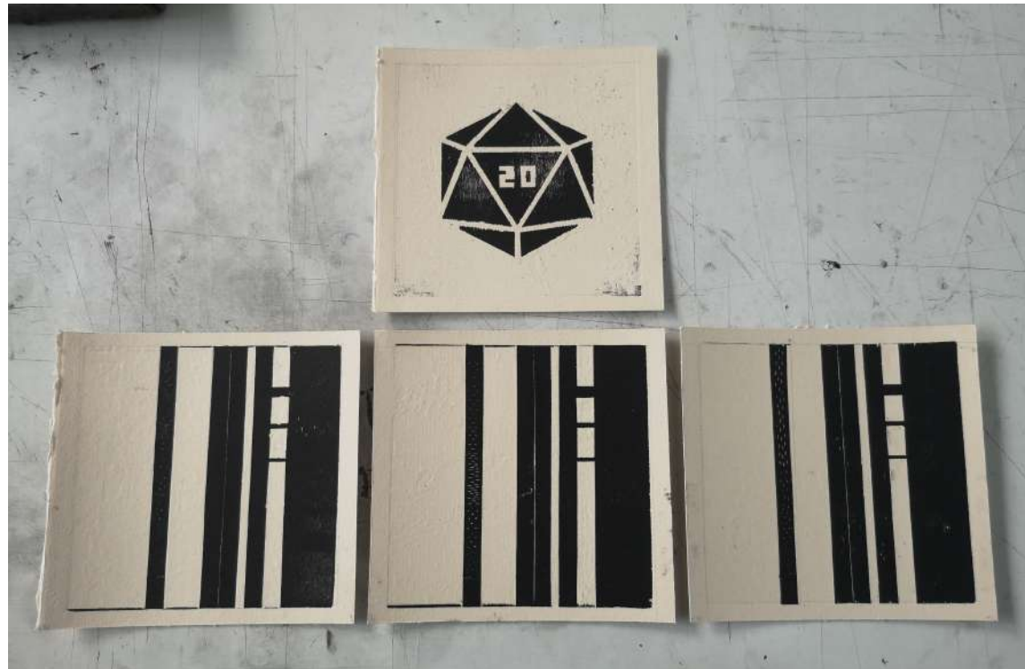
I. Pruebas con plataformas (arriba) y con plantillas (abajo). De izquierda a derecha: cartulina, vegetal y acetato).
