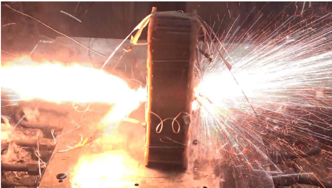
Figura 21: Batería de litio fallando debido al mal uso [33]
