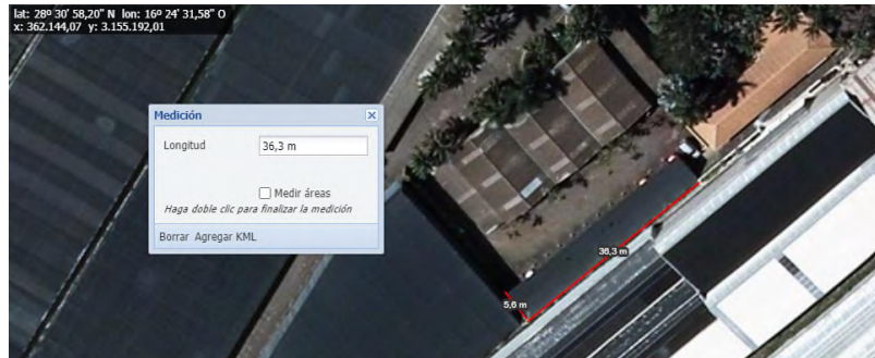
Figura 17. Zona de instalación de los paneles. Fuente: GrafCan
