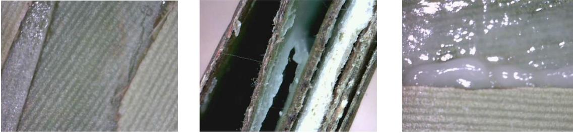
**Figura 89.** Fotografías microscópicas de la superficie superior, sección transversal y superficie inferior de 6H-3R, tras los ensayos a tracción. (Fuente propia)
