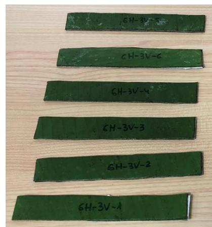
**Figura 54.** Probetas de hoja de platanera con papel reciclado. (Fuente: propia)
