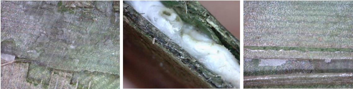
**Figura 85.** Fotografías microscópicas de la superficie superior, sección transversal y superficie inferior de 6H-3R, tras los ensayos a tracción. (Fuente propia)
