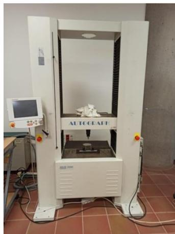
**Figura 59.** Máquina Shimadzu Autograph AG-IS. (Fuente: propia)
