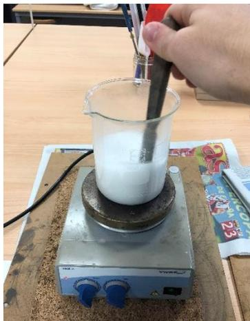
**Figura 39.** Proceso de calentamiento y agitación de la mezcla para elaborar el adhesivo (Fuente: propia)
