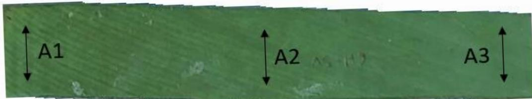
Figura 58. Medición de anchura en las probetas. (Fuente: propia)
