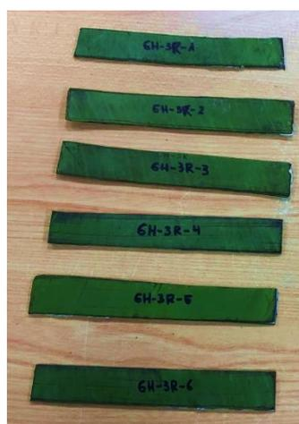
**Figura 50.** Probetas de hoja de platanera con papel reciclado. (Fuente: propia)
