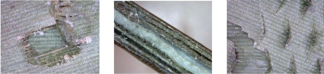
**Figura 87.** Primera serie de fotografías microscópicas de la superficie superior, sección transversal y superficie inferior de 6H-3V, tras los ensayos a tracción. (Fuente propia)
