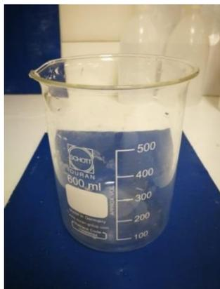
*Figura 26. Vaso de precipitado empleado para medir volumen de agua (Fuente: propia)*
