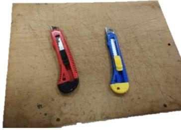
**Figura 22.** Cúteres empleados para recortar las muestras (Fuente: propia)
