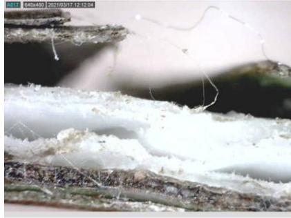
**Figura 92.** Fotografía microscópica adicional de 4H-5V con rotura parcial de las capas. (Fuente: propia)
