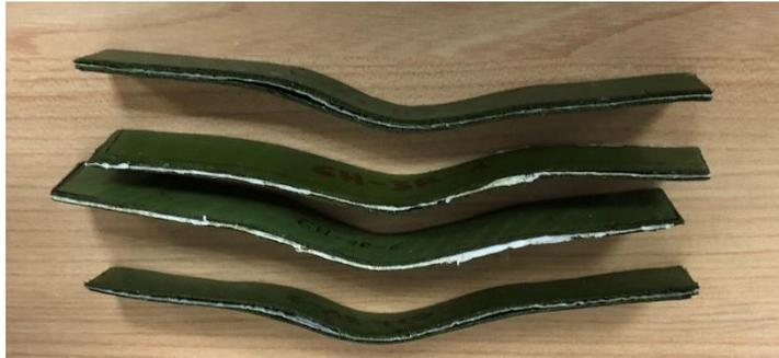
**Figura 80.** Vista lateral de probetas fabricadas con hoja de platanera y papel vegetal tras los ensayos a flexión. (Fuente: propia)
