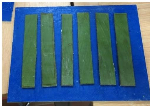
**Figura 46.** Probetas de hoja de platanera a base de almidón de arroz. (Fuente: propia)
