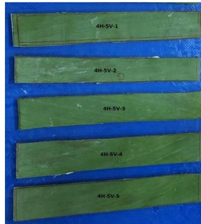
**Figura 52.** Probetas de hoja de platanera con papel vegetal. (Fuente: propia)
