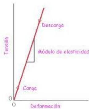
**Figura 65.** Cálculo del módulo de elasticidad en la curva esfuerzo-deformación [45].
