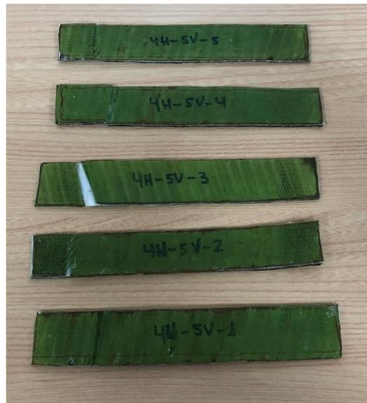
**Figura 79.** Vista frontal de probetas fabricadas con hoja de platanera y papel vegetal tras los ensayos a tracción. (Fuente: propia)
