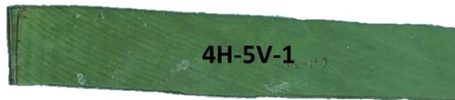
**Figura 55.** Probetas de hoja de platanera con papel vegetal. (Fuente: propia)
