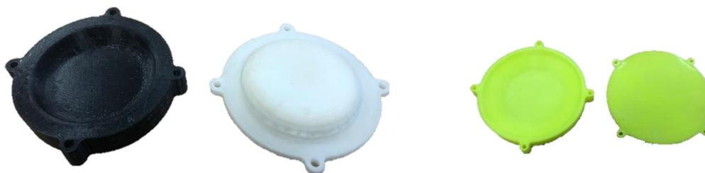
**Figura 93.** Moldes de mayor y menor tamaño respectivamente, fabricados con la impresora 3D. (Fuente propia)
