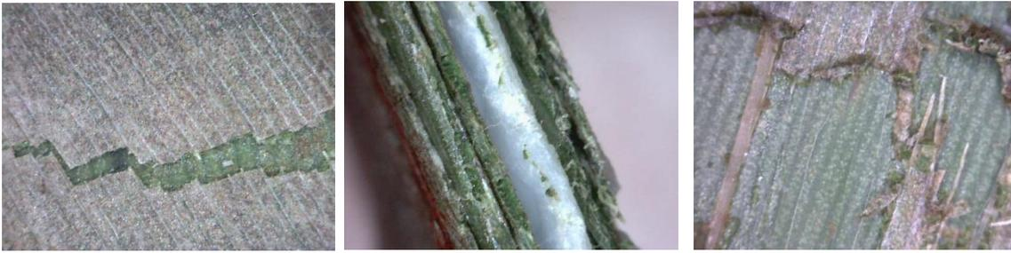
**Figura 82.** Fotografías microscópicas de la superficie superior, sección transversal y superficie inferior de 6H-3V, tras los ensayos a tracción. (Fuente propia)
