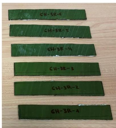
**Figura 53.** Probetas de hoja de platanera con papel vegetal. (Fuente: propia)
