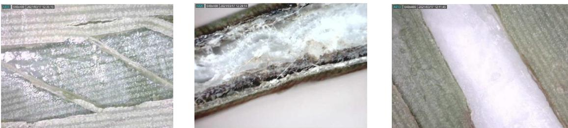
**Figura 91.** Fotografías microscópicas de la superficie superior, sección transversal y superficie inferior de 4H-5V, tras los ensayos a tracción. (Fuente propia)
