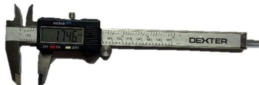
**Figura 56.** Calibrador digital "pie de rey" utilizado para medir el espesor de las probetas. (Fuente: propia)
