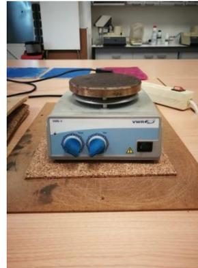
**Figura 38.** Agitador magnético con calefacción, VMS-A. (Fuente: propia)
