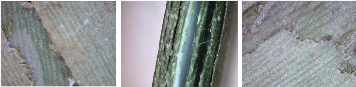
**Figura 83.** Fotografías microscópicas de la superficie superior, sección transversal y superficie inferior de 6H-1V-1R, tras los ensayos a tracción. (Fuente propia)
