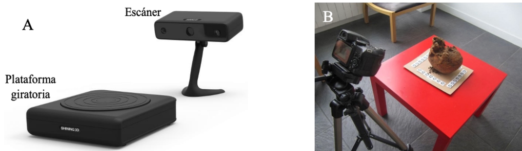
Figura 2. A: Componentes del equipo de EL3D, LaserScan - Einscan S. B: Proceso de documentación fotogramétrica de un cráneo (Autora: Itxaso Azcune).
