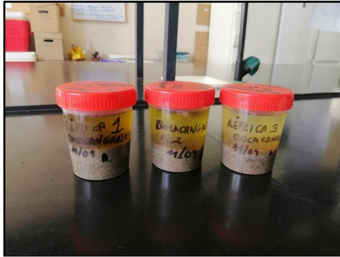
Figura 5. Botes con la muestra final, proveniente del filtrado del lavado del colector.
