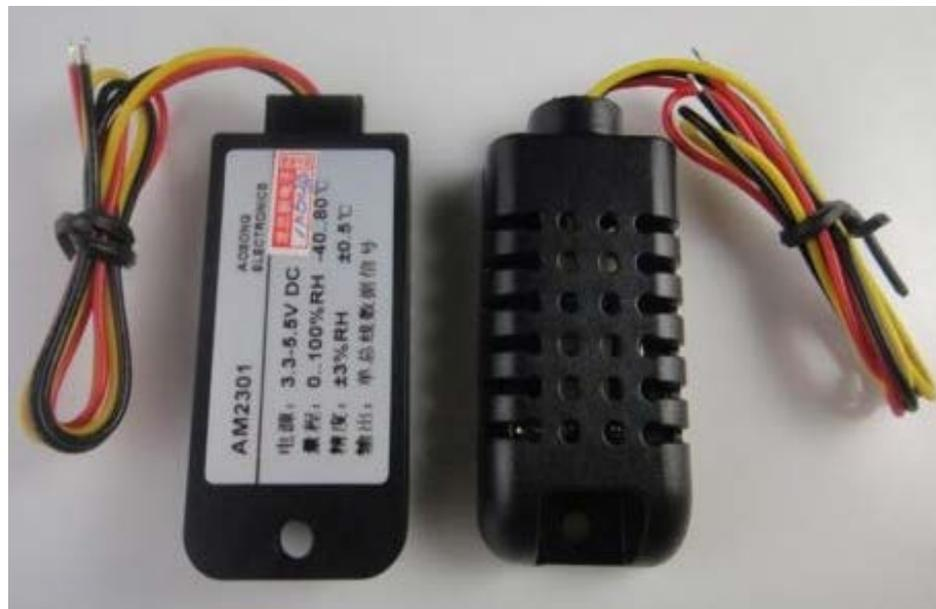
Figura 2. Sensor DHT21/AM2301.
