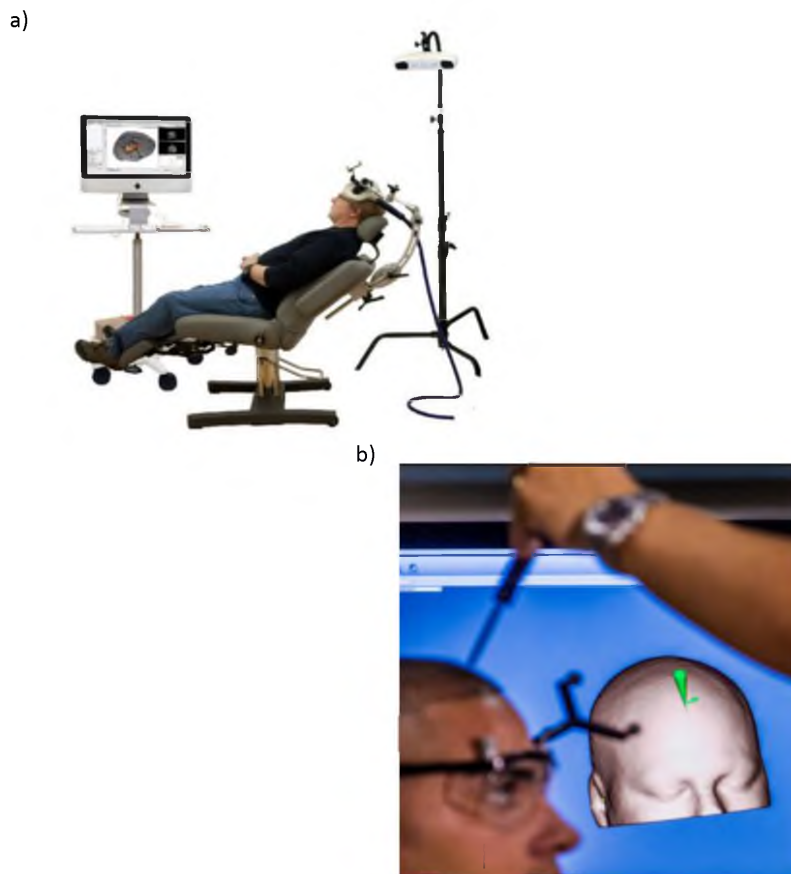
Figura 42. a) Setup de neuronavegación formado por una cámara NDI Vicra para censar el posicionamiento del sujeto en un entorno 3D y rastrear el movimiento del puntero, ordenador que porta el software BrainSight y un sillón que permite fijar el movimiento de la cabeza. b) Imagen del puntero sobre el espacio real y su proyección en el espacio renderizado desde MRI (Ashburner et al. , 2008).
