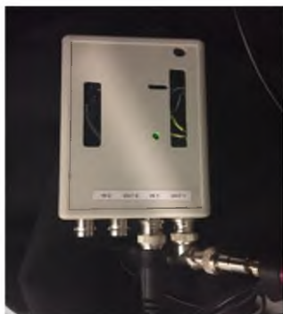
Figura 35. Imagen izquierda muestra el microcontrolador como parte del hardware del sistema DYNOT para sincronizar los pulsos de salida.
