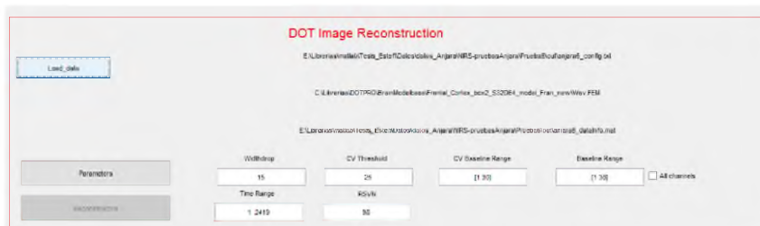
Figura 54. Sección de la interfaz DOTPRO dedicada a la reconstrucción de la imagen DOT ( DOT Image Reconstruction ). Tres archivos son leídos desde la interfaz: *.config.txt, *.Wsv y *dataInfo.mat. Los parámetros que definen la reconstrucción de la imagen son dados desde la interfaz ( Parameters ): umbral del coeficiente de variación ( CV Threshold ), rango de tiempo basal para el coeficiente de variación ( CV Baseline Range ), rango de tiempo basal para normalizar los canales ( Baseline Range ), todos los canales ( All channels ) incluye canales sin tratar en la reconstrucción de la imagen. Para la reconstrucción de la imagen DOT ( Reconstruction ) se muestra el tiempo experimental en frames ( Time Range ) y el porcentaje de valores singulares que determinan la dimensionalidad de la matriz jacobiana ( RSVN ).
