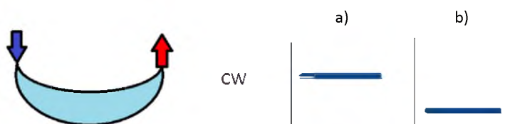
Figura 24. Imagen izquierda. Esquema de la trayectoria óptica (forma banana) de los fotones en un medio turbio como es el tejido humano. Flecha azul representa al emisor, mientras que la flecha roja representa al detector. Imagen derecha. Representación de a) intensidad de luz emitida y b) intensidad de luz detectada para un sistema de CW. La intensidad de luz es atenuada y constante. El eje de las abscisas representa el tiempo. El eje de las ordenadas representa la intensidad de luz.
