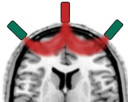
Figura 22. Esquema del fNIRS modo topográfico. Los emisores (rojo) y los detectores (verde) se encuentran colocados a una distancia de 2-4 cm entre ellos. La trayectoria óptica de los fotones forma un elipsoide conocida como onda banana. La combinación entre emisores y detectores forman los canales ópticos que representan los cambios de atenuación de la luz procedentes de la corteza cerebral.
