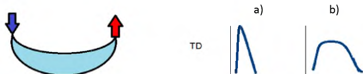
Figura 26. Imagen izquierda. Esquema de la trayectoria óptica (forma banana) de los fotones en un medio turbio como es el tejido humano. Flecha azul representa al emisor, mientras que la flecha roja representa al detector. Imagen derecha. Representación de a) intensidad de luz emitida y b) intensidad de luz detectada para el sistema en TD. La intensidad de luz disminuye y aparece una cola en el TRPF. El eje de las abscisas representa el tiempo. El eje de las ordenadas representa la intensidad de luz.
