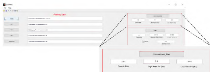
Figura 52. Sección de la interfaz de DOTPRO para el filtrado digital ( Conventional filter ), el ancho de banda o frecuencia de corte ( High Pass y/o Low Pass ) y la frecuencia de muestreo ( Sampling Rate ).
