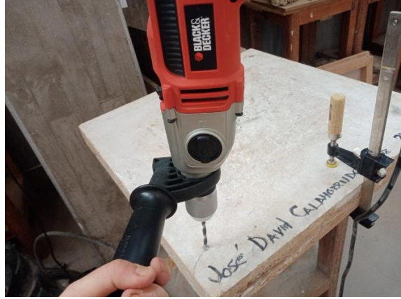
Fig.44.- Proceso de perforado en la madera para la colocación de los clavos.
