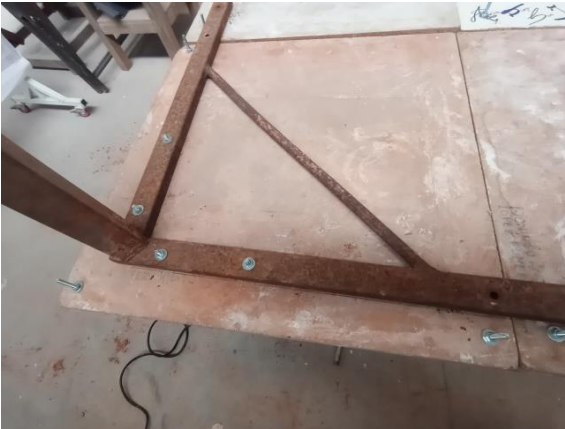
Fig.45.- Perforado de la estructura de soporte con tornillos incorporados.
