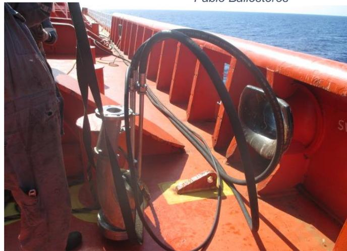
Ilustración 13: imagen de la conexión de las mangueras a la bomba de emergencia. Fuente: archivos de Pablo Ballesteros
