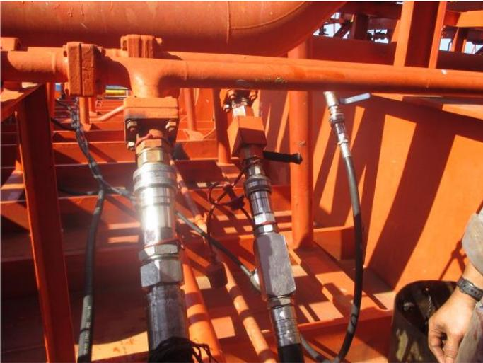
Ilustración 15: imagen de la conexión de las mangueras a la línea hidráulica. Fuente: archivos de Pablo Ballesteros
