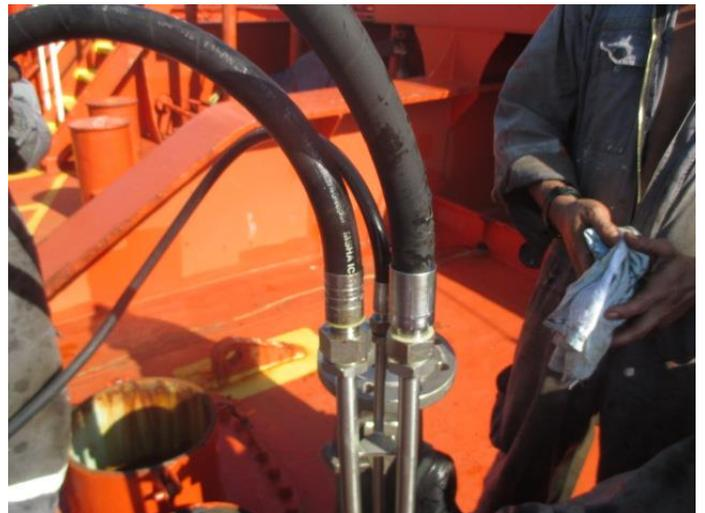
Ilustración 14: imagen de la conexión de las mangueras a la bomba de emergencia. Fuente: archivos de Pablo Ballesteros
