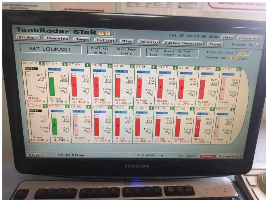
Ilustración 17: imagen del monitor de la sonda-radar. Fuente: archivos de Pablo Ballesteros
